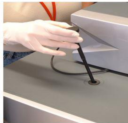
Figure 7 : Insertion du porte-injecteur dans le port de l'injecteur
