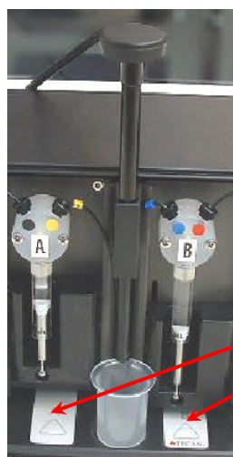
Figure 29 : Boîte de l'injecteur avec injecteur en position de service ; les injecteurs sont retirés du logement du porte-injecteur et insérés dans le support du système de porte-injecteur.
