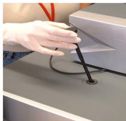
Obrázek 7: Vložení držáku injektoru do otvoru na injektor
