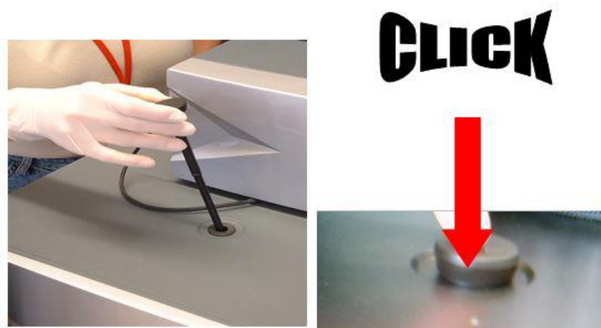
Рис. 7. Установка штатива инжектора в порт инжектора
