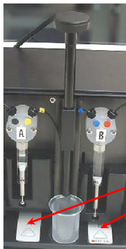
Рис. 29. Инжекторный модуль с инжектором в положении обслуживания ; инжекторы извлечены из гнезда штатива инжектора и вставлены в держатель системы штатива инжектора
