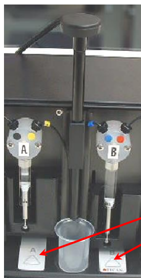
Figura 29: Caja de inyector con inyector en service position (posición de servicio); se retiran los inyectores de la ranura del portador y se introducen en el soporte del sistema portador del inyector.
