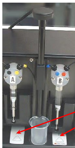
Figura 29: Caixa de injetor com injetor na posição de serviço ; os injetores estão retirados da ranhura do transportador e inseridos no suporte do sistema do transportador de injetor.
