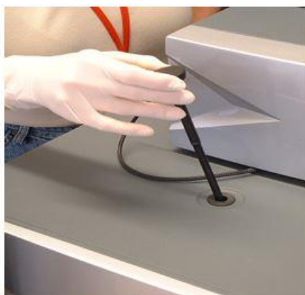
Figura 7: Inserção do transportador de injetor na porta do injetor
