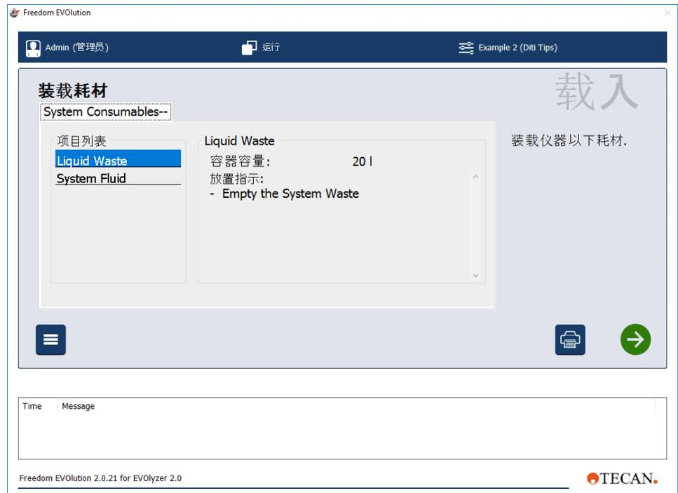
图 4-12 装载耗材对话框：装载废液和系统液体容器
