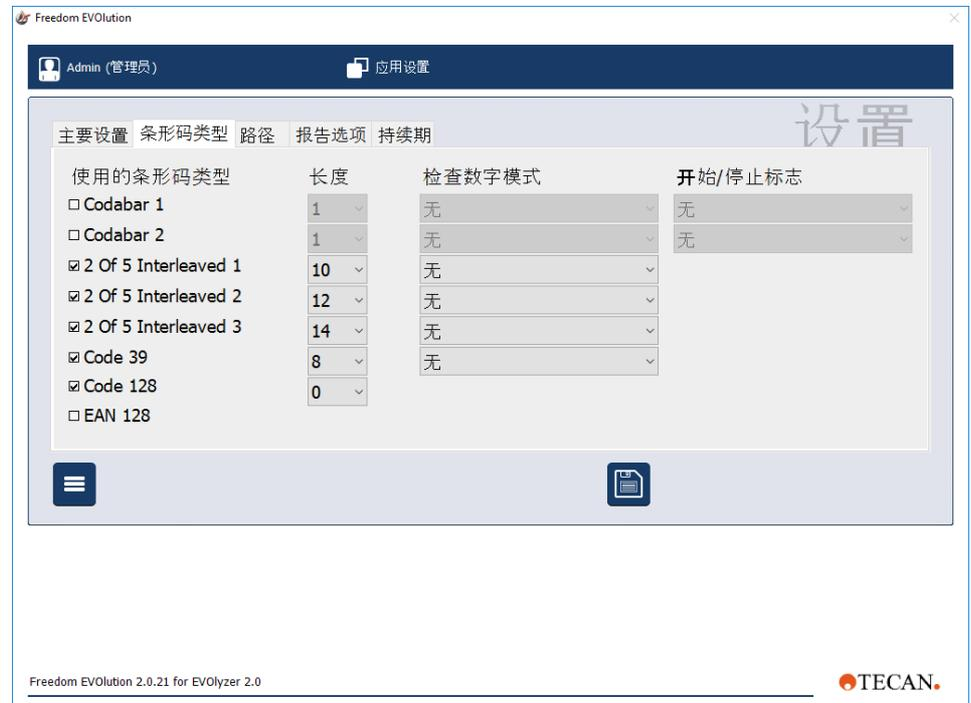
图 4-31 条形码类型对话框
