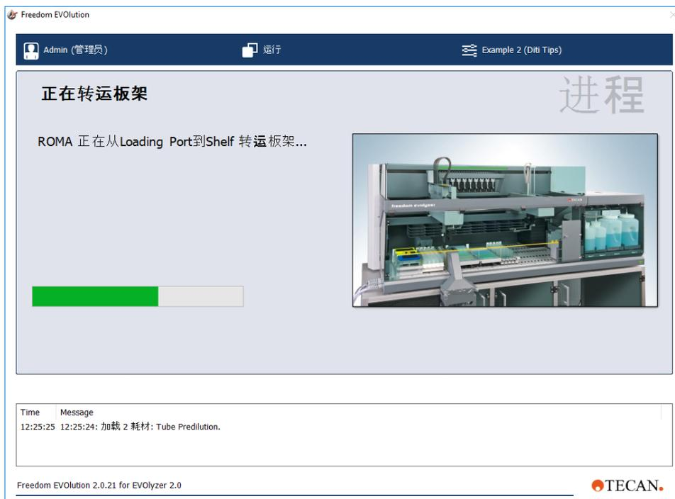
图 4-23 正在转运板架对话框
