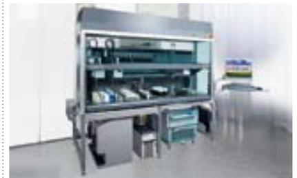
Mit Liquid-Handling-Workstations lässt sich die Produktion monoklonaler Antikörper vollständig automatisieren.
