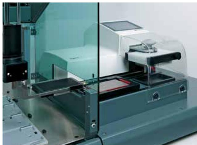
einem Microarray analysieren, sowie Washer, die Wasch- und Aufreinigungsschritte eines Versuchsablaufs durchführen.
