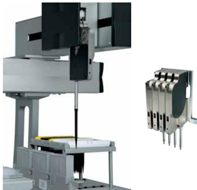
Die Cavro XMP 6000 Mehrkanalpumpe wird beispielsweise in Instrumenten aus dem schnell wachsenden Bereich der Genomsequenzierung (Next Generation Sequencing) eingesetzt. Der Cavro® Omni Robot ist eine universell einsetzbare Liquid-Handling-Komponente, die von Instrumentenherstellern beispielsweise für den Einsatz in der Life-Science-Forschung und der klinischen Diagnostik integriert wird. Ein Anwendungsbeispiel wird auf den Seiten 8 bis 9 beschrieben.
