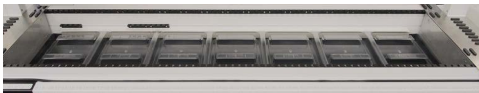
Fig. 19: Dækbakker under dæksegmenterne
