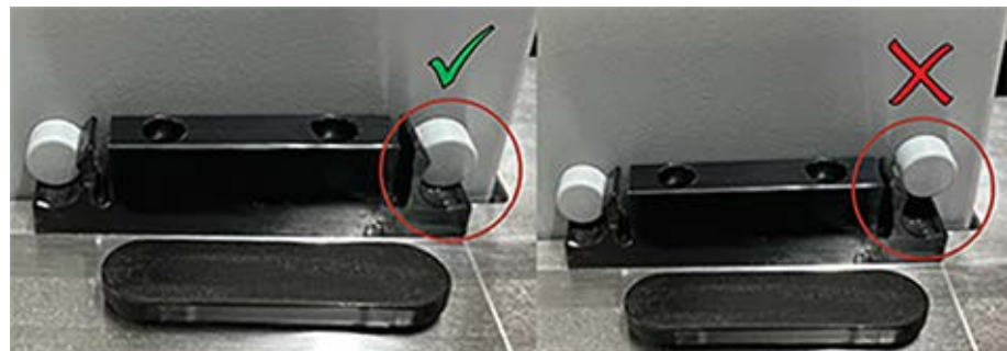
Fig. 54: Korrekt montering af affaldsslisen på arbejdsbordet
