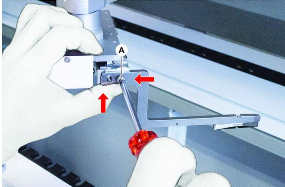
2. Drücken Sie den Greiferfinger gegen den oberen und den hinteren Anschlag der Greiferkopfhalterung und ziehen Sie die Schraube mit einem Drehmomentschraubendreher (3 oder 3,5 Nm) an.
