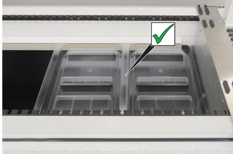
Abb. 43: Ordnungsgemäße Anordnung der Auffangschalen
