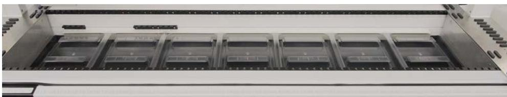
Abb. 19: Auffangschalen unter den Deck-Segmenten
