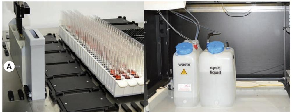
Abb. 26: Flüssigkeitssystem (Liquid FCA)
