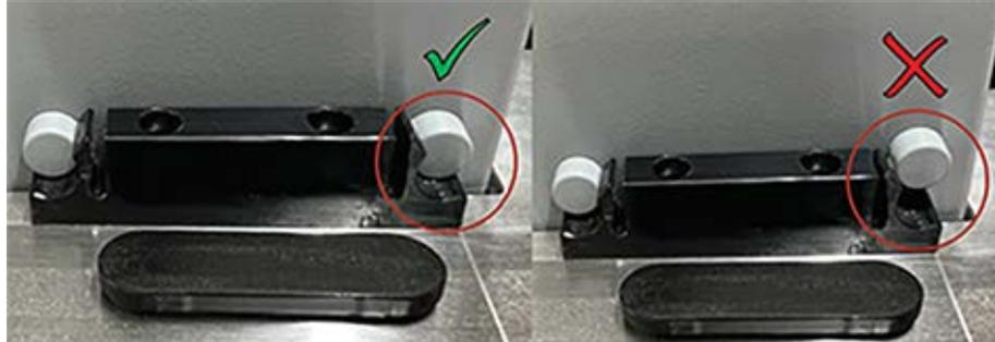
Abb. 54: Korrekte Montage der Abfallrutsche auf der Arbeitsfläche
