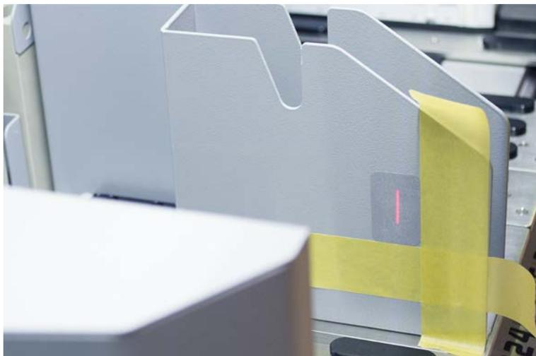
3. Entfernen Sie das Klebeband von der DiTi-Abfallrutsche.
