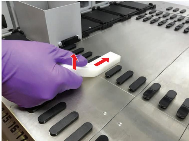
2. Heben Sie den Griff des Zapfenentferners an und ziehen Sie den Zapfen aus dem Deck-Segment.
