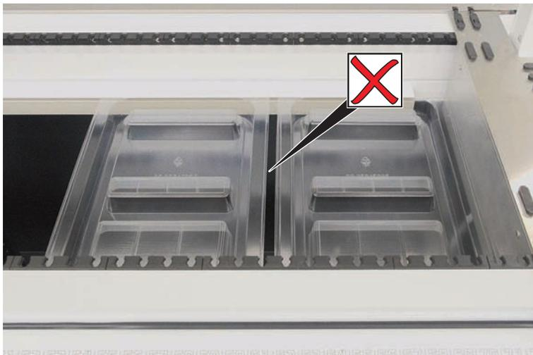
Abb. 41: Falsche Anordnung der Auffangschalen
