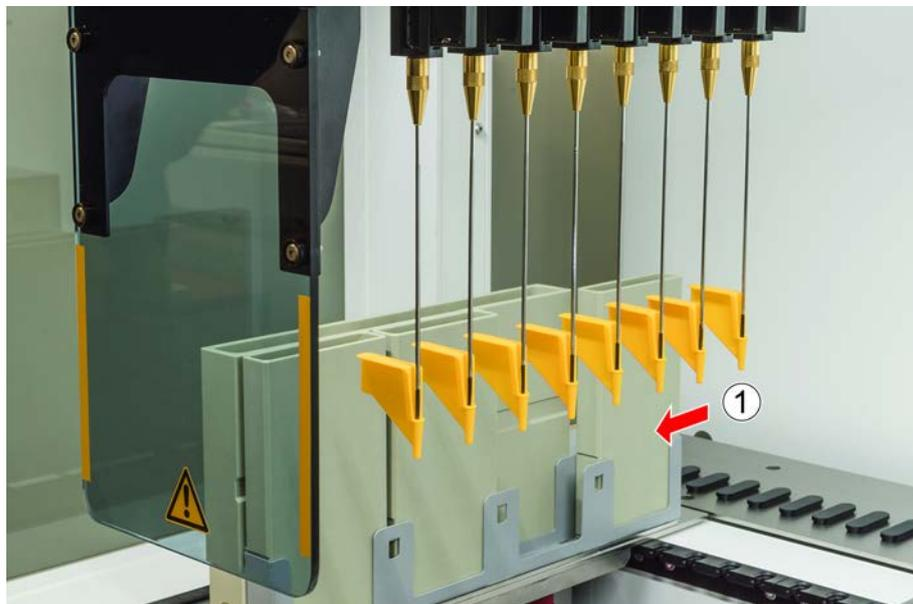
6. Schrauben Sie die Sicherungsmutter ab, während Sie die Piercing-Spitze unmittelbar unter der Sicherungsmutter mit der anderen Hand halten.
