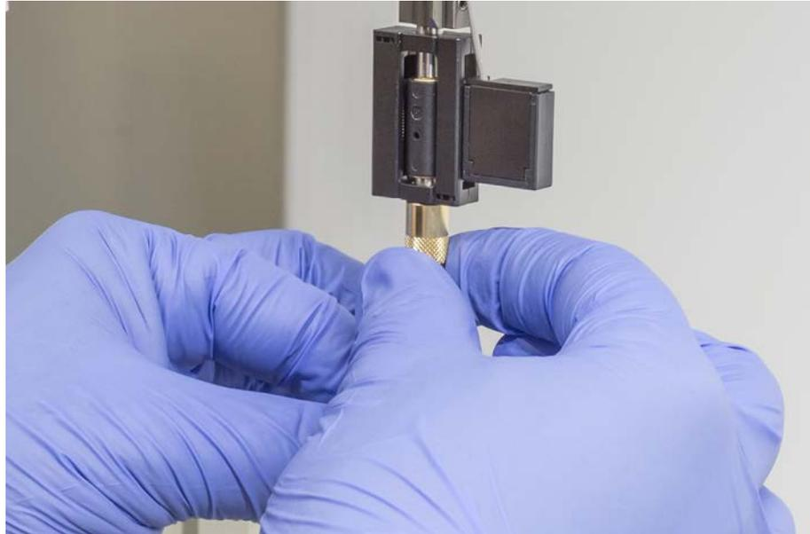
10. Lösen Sie die Sicherungsmutter ein wenig. Schieben Sie den Spitzenschutz etwas nach unten, um Zugang zum Schaft der Piercing-Spitze zu erhalten. Entfernen Sie den Spitzenschutz noch nicht vollständig.
