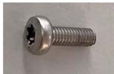
B) Tornillo Allen M4x12 combinado con una arandela de tensión (observe la posición de acuerdo con la siguiente ilustración), apretado a un par de torsión de 3,5 Nm.
