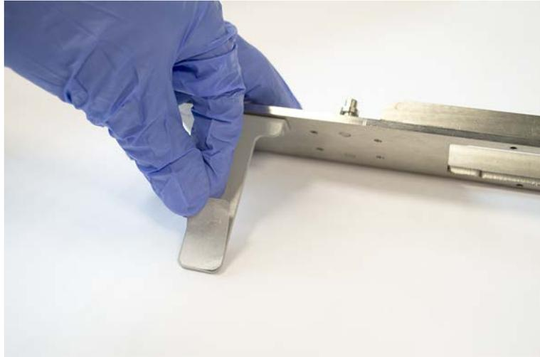
**7.5.10 Colocación de la lámina reflectante Fluent ID en el tobogán de residuos de puntas desechables**
