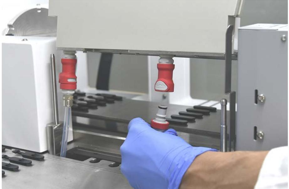
2. Monte la estación de lavado en los ejes guía (A) y presiónela sobre la placa base.
