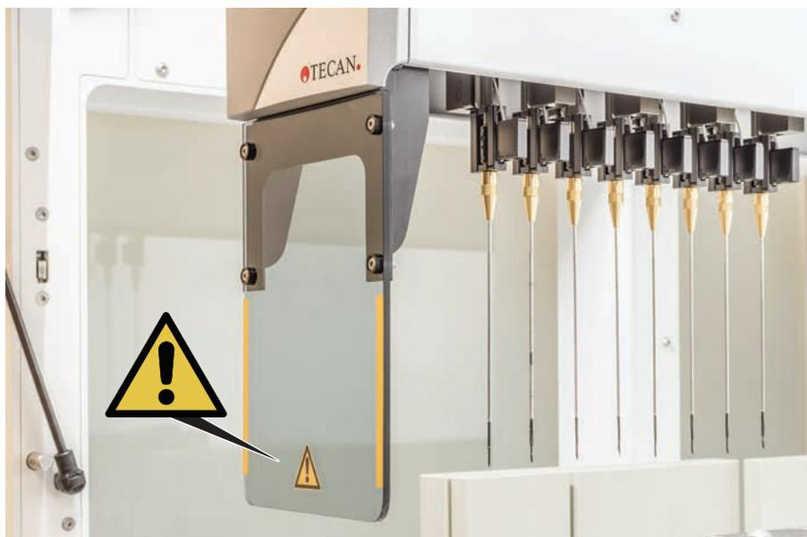
Fig. 12: Placa de seguridad
