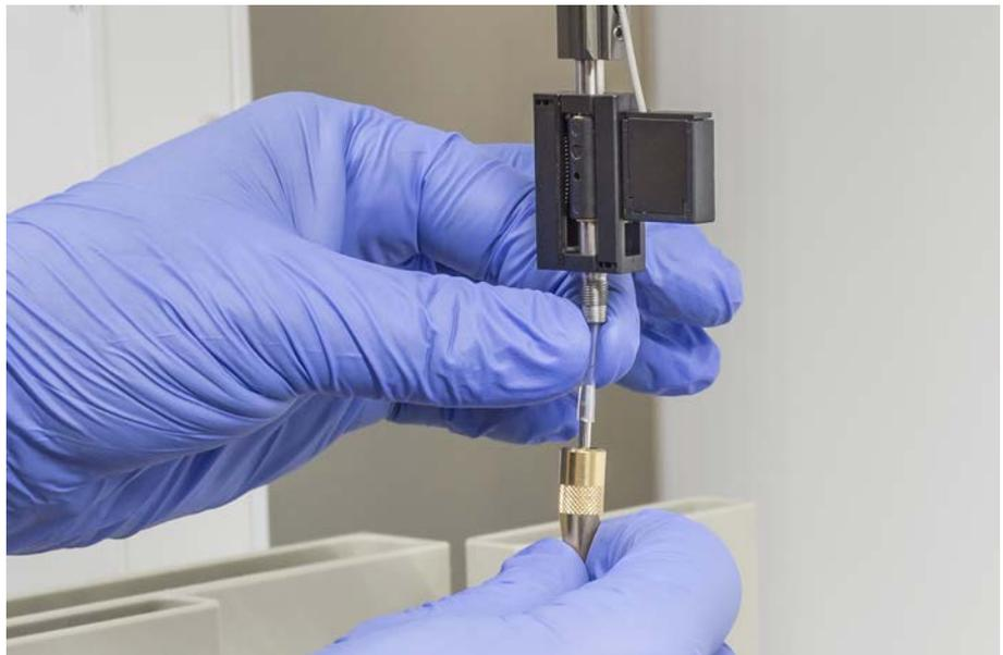
8. Introduzca la punta de perforación y el tubo de pipeteo en el adaptador de puntas.
