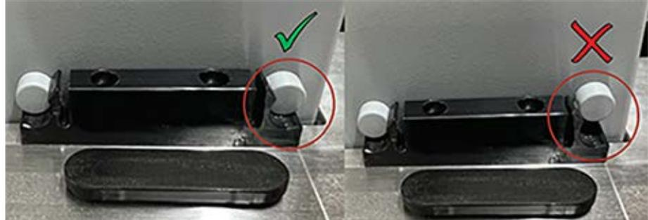
Fig. 54: Montaje correcto del conducto de desechos en la mesa de trabajo
