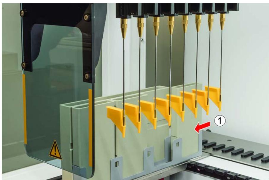
6. Desenrosque la tuerca de bloqueo sujetando la punta con la otra mano justo por debajo de la tuerca de bloqueo.
