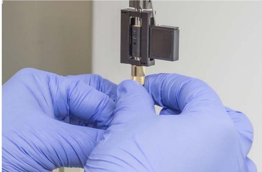
10. Ouvrir légèrement l'écrou-frein. Déplacer la protection de l'embout légèrement vers le bas afin d'accéder à la tige de l'embout de perçage. Ne pas encore retirer complètement la protection de l'embout.
