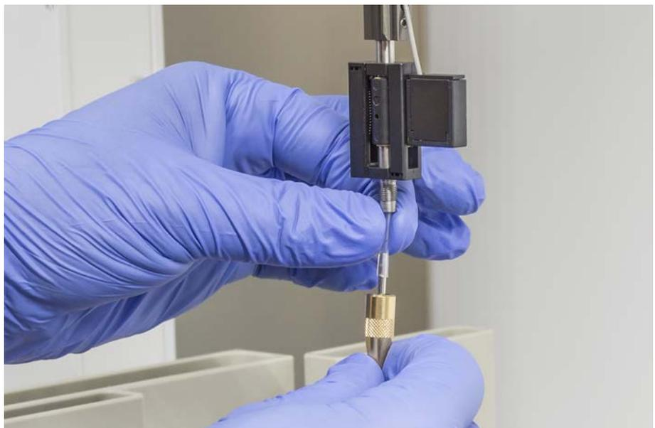
8. Insérer l'embout de perçage et le tube de pipetage dans l'adaptateur d'embout.
