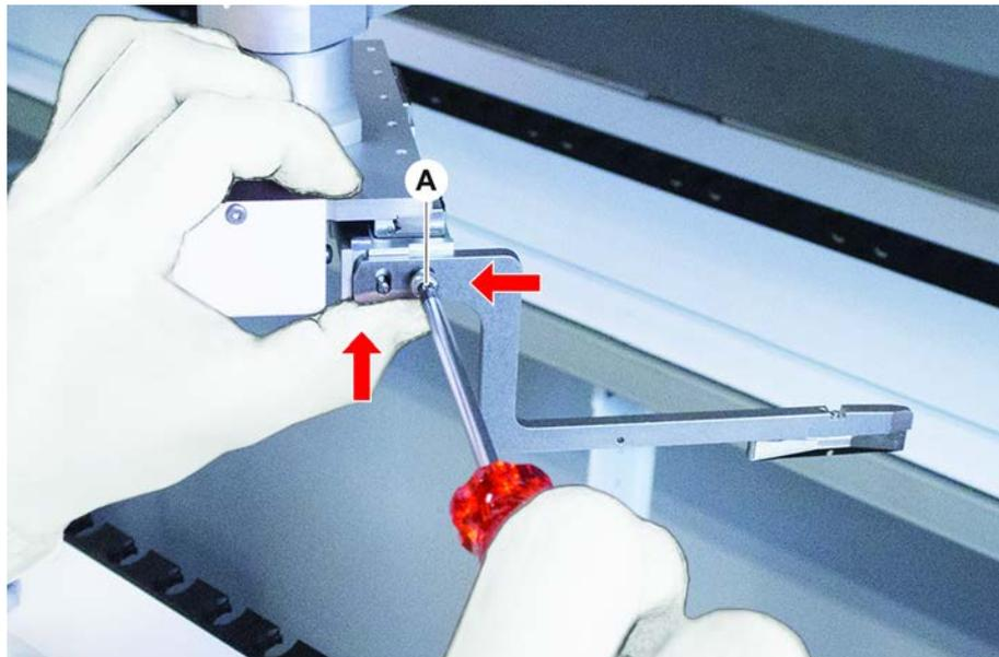
2. Appuyer les doigts préhenseurs contre la butée supérieure et la butée arrière du support de la tête de préhension et serrer la vis au tournevis dynamométrique (3 ou 3,5 Nm).
