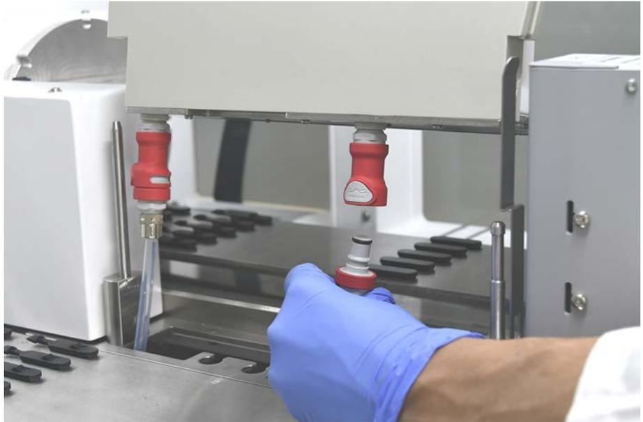
2. Monter la station de lavage sur les arbres de guidage (A) et la presser sur la plaque de base. Vérifier que le levier de dégagement s'enclenche et maintient la station de lavage en position.
