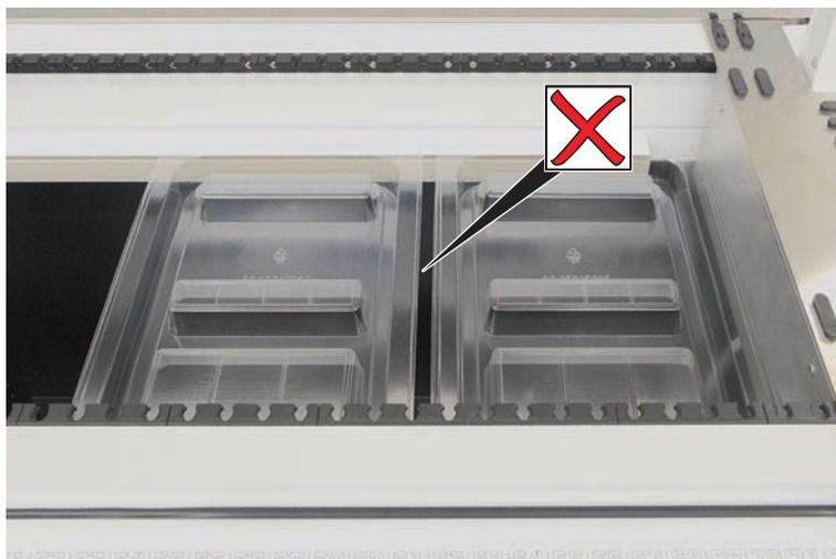
*Fig. 41: Bacs mal positionnés*
