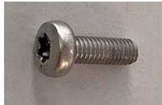
b) vis Allen M4x12 en combinaison avec une rondelle de tension (observer la position sur l'illustration ci-dessous), serrée à un couple de 3,5 Nm.
