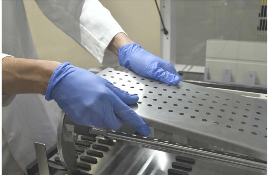
3. Pulire la piastra del supporto secondo le istruzioni generali sopra indicate, in alternativa è possibile incubare il supporto per provette in un bagno con candeggina al 2% per un massimo di 2 ore.
