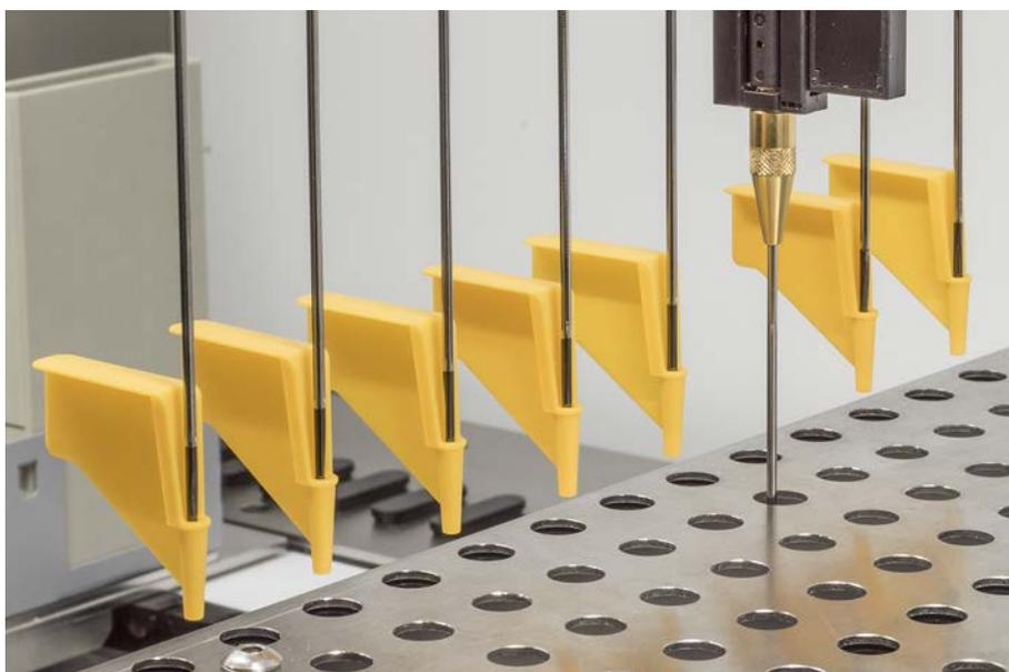
4. Posizionare lo strumento per la rimozione dei puntali perforanti vicino al puntale bloccato su una superficie solida e stabile e inserirlo sotto il controdado.
