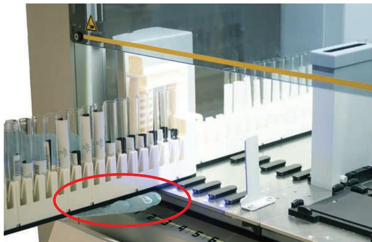
5. Inserire i portaprovette in successione sulle apposite griglie nell'area di carico di Fluent ID.
