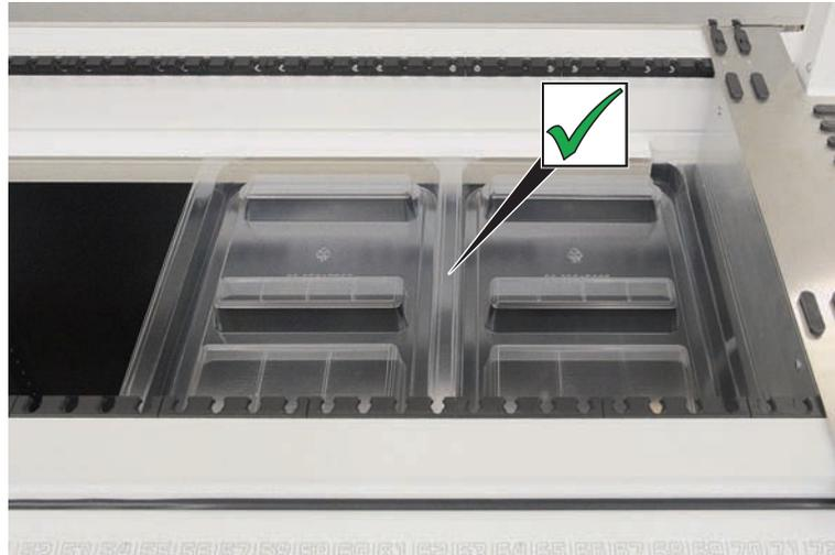
Fig. 43: Posizionamento corretto delle vaschette di raccolta
