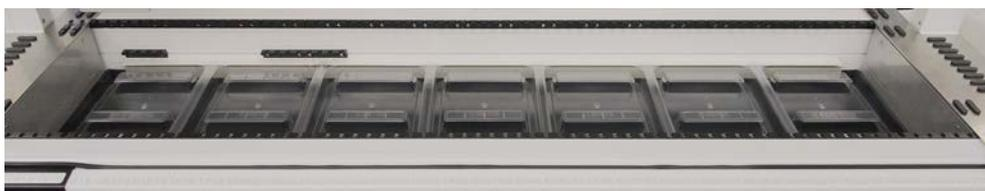
Fig. 19: Vaschette di raccolta sotto i segmenti del piano di lavoro
