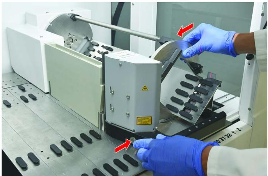
3. Ruotare il tamburo manualmente e rilasciare il pulsante di sblocco del solenoide.
