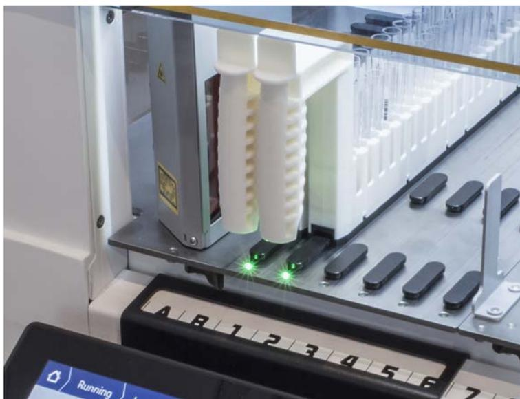
7. Se durante la lettura dei codici a barre si verifica un errore, scaricare il portaprovette, eliminare il problema e ricaricare il portaprovette.
