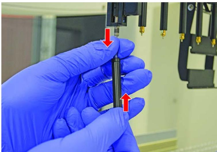
4. Tenere fermi l'adattatore del puntale (D) e il tubo di espulsione del puntale (C).
