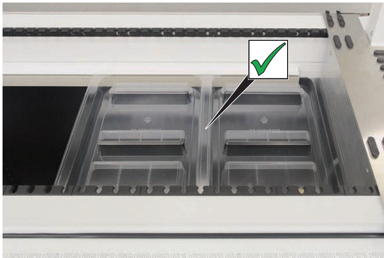
Obr. 46: Správné umístění podnosu plošiny
