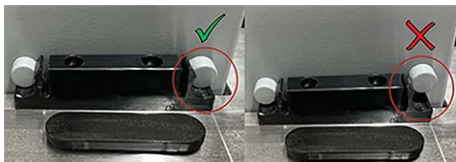
Obr. 57: Správná montáž odpadního skluzu na pracovním stole
