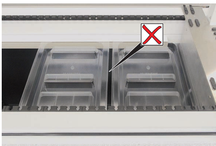
Obr. 44: Nesprávné umístění podnosu plošiny
