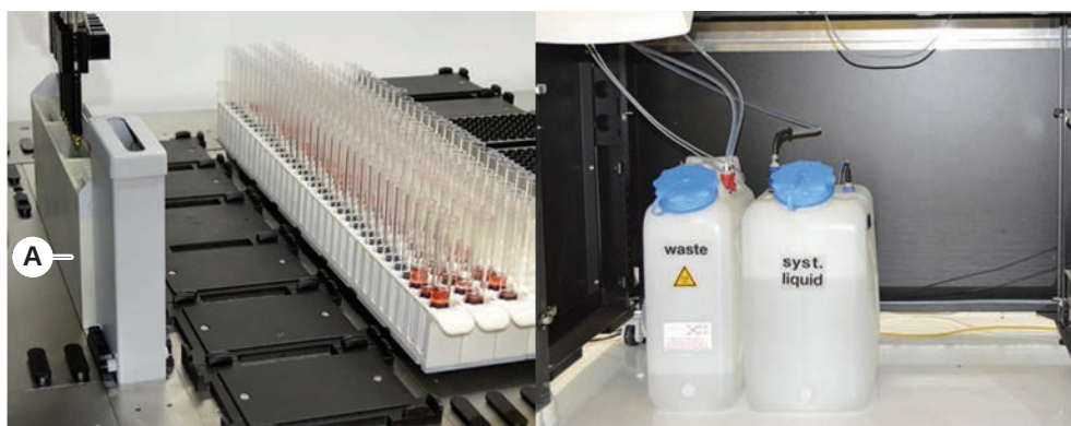
Obr. 28: Kapalinový systém (FCA s kapalinovým systémem)
