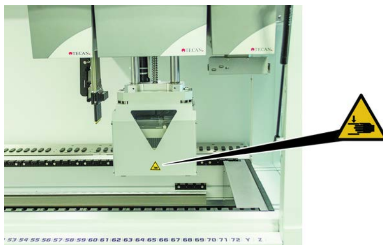
Fig. 11: Sikkerhedsskilt på MCA 384
