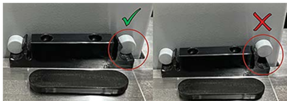
Fig. 57: Korrekt montering af affaldsslisken på arbejdsbordet
