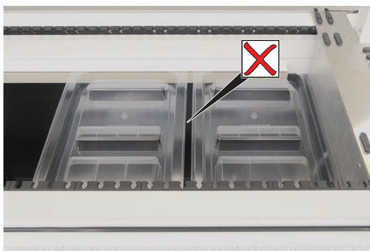
Fig. 44: Ukorrekt placering af dækbakker
