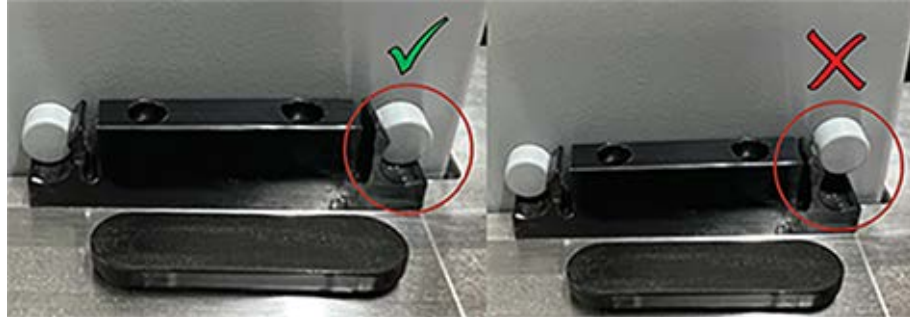
Abb. 57: Korrekte Montage der Abfallrutsche auf der Arbeitsfläche
