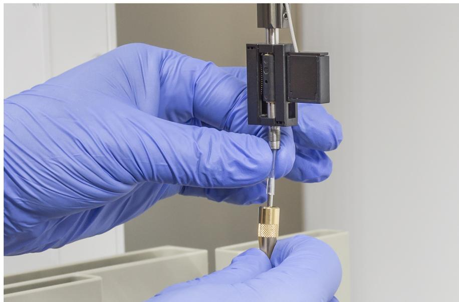
8. Schieben Sie die Piercing-Spitze und den Pipettierschlauch in den Spitzenadapter.
