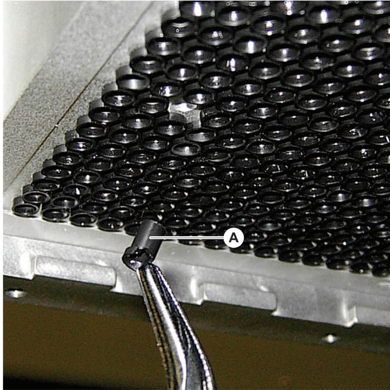
7. Schmieren Sie den neuen Dichtring mit einem dünnen Film Mineralöl.
