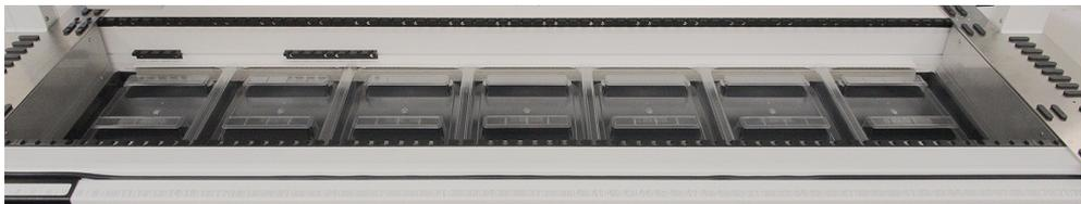
Abb. 20: Auffangschalen unter den Deck-Segmenten
