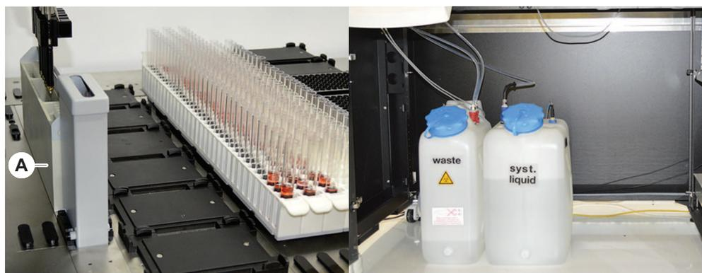
Abb. 27: Flüssigkeitssystem (Liquid FCA)
