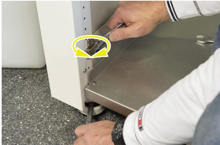
6. Ziehen Sie die Sicherungsmuttern an den Füßen des Unterbaus nach dem Nivellieren wieder an.
