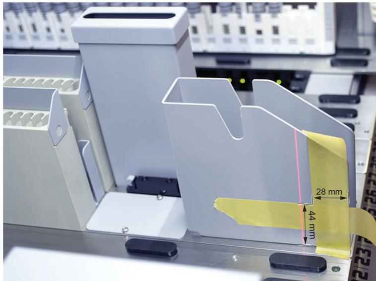
2. Bringen Sie die neue selbstklebende Reflektorfolie wie auf der Abbildung unten an der DiTi-Abfallrutsche an.
