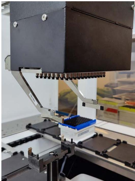
Fig. 25: Cabezal/pinza MCA 96
