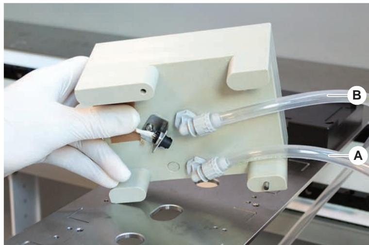
3. Conecte el tubo de lavado (A) y el tubo de residuos (B).
