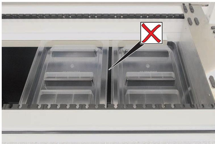
Fig. 44: Colocación incorrecta de las bandejas de recogida
