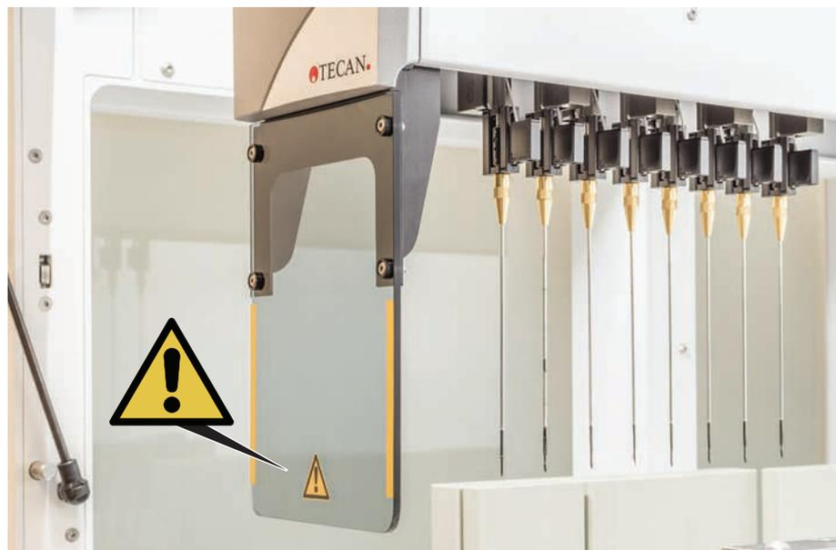
Fig. 13: Placa de seguridad
