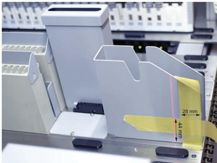
2. Coloque la nueva lámina reflectante autoadhesiva en el tobogán de residuos de puntas desechables según se muestra en la figura de abajo.
