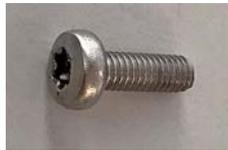
B) Tornillo Allen M4x12 combinado con una arandela de tensión (observe la posición de acuerdo con la siguiente ilustración), apretado a un par de torsión de 3,5 Nm.
