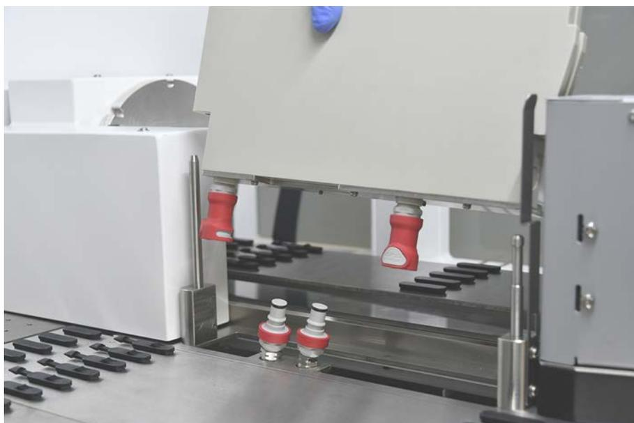
**Montaje de la estación de lavado del posicionador rotativo de tubos**
