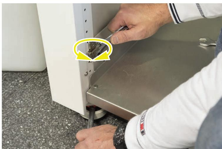
6. Una vez nivelado el equipo, vuelva a apretar las tuercas de bloqueo de las patas del armario.
