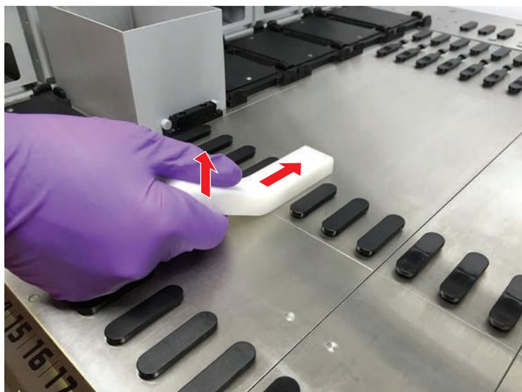
2. Levante el mango del extractor de pines y extraiga el pin del segmento de plataforma.
