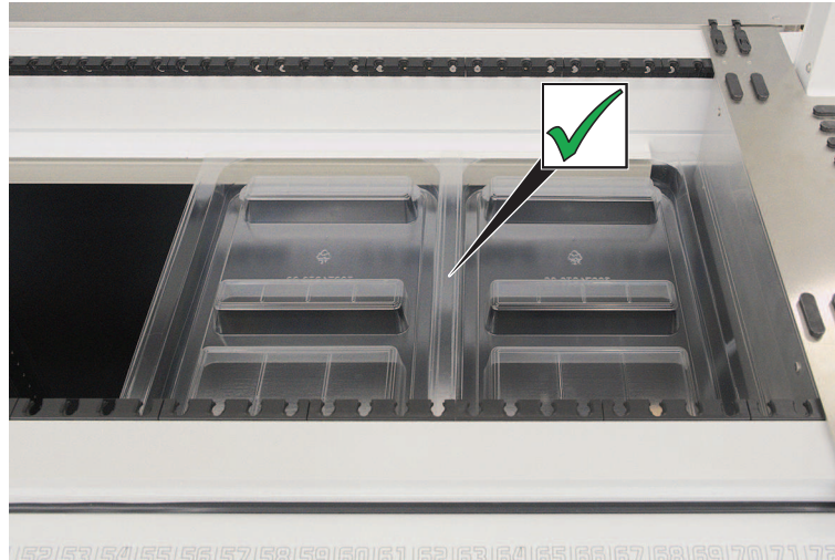
Fig. 44: Colocación correcta de las bandejas de recogida
