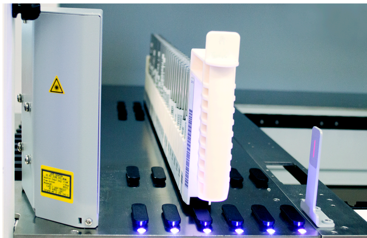
Fig. 39: LEDs de Fluent ID
