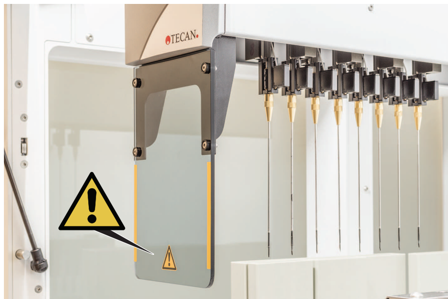
Fig. 13: Placa de seguridad
