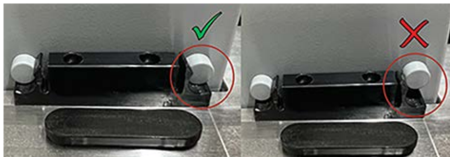
Fig. 57: Montaje correcto del conducto de desechos en la mesa de trabajo
