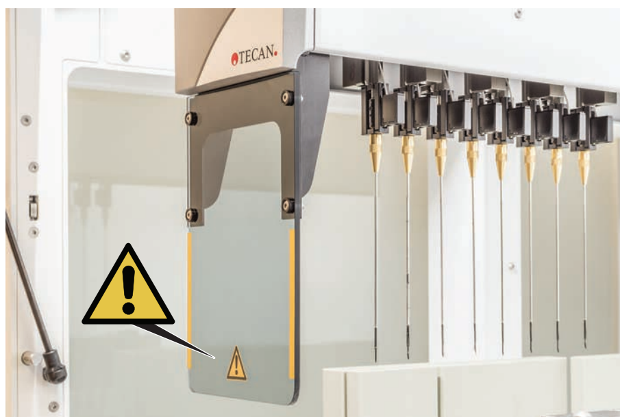
Fig. 13: Placa de seguridad
