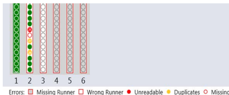
Fig. 43: Confirmación de la lectura del código de barras visualizada en la pantalla táctil
