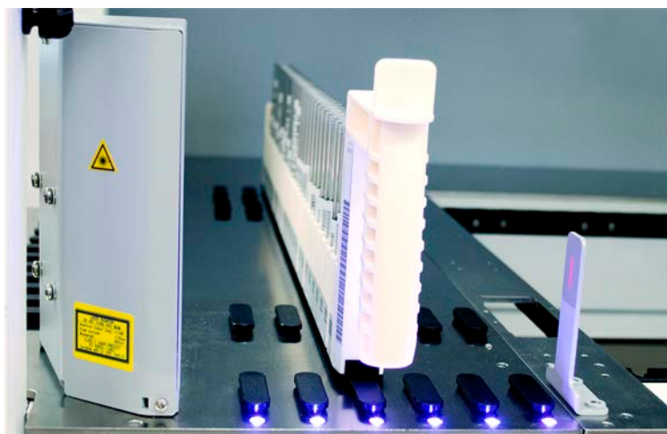
Fig. 41: LEDs de Fluent ID
