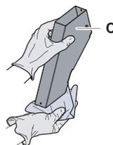
Fig. 52: Manipulation de la goulotte d'évacuation des embouts jetables
