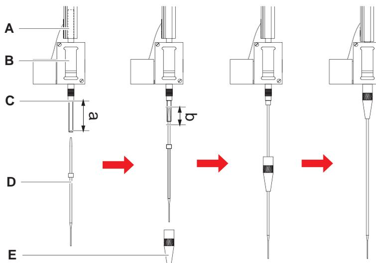
Fig. 65: Mise en place d'un embout standard
