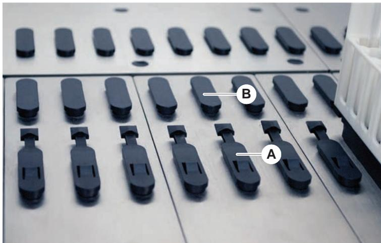
*Fig. 21: Goupilles de verrouillage et de positionnement*
