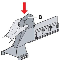
Fig. 53: Remettre l'insert de goulotte d'évacuation des embouts jetables en place
