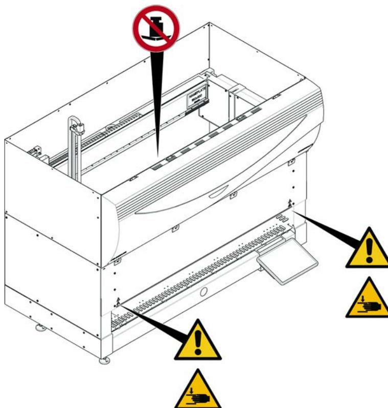
Fig. 9: Appareil avec demi panneau de sécurité avant
