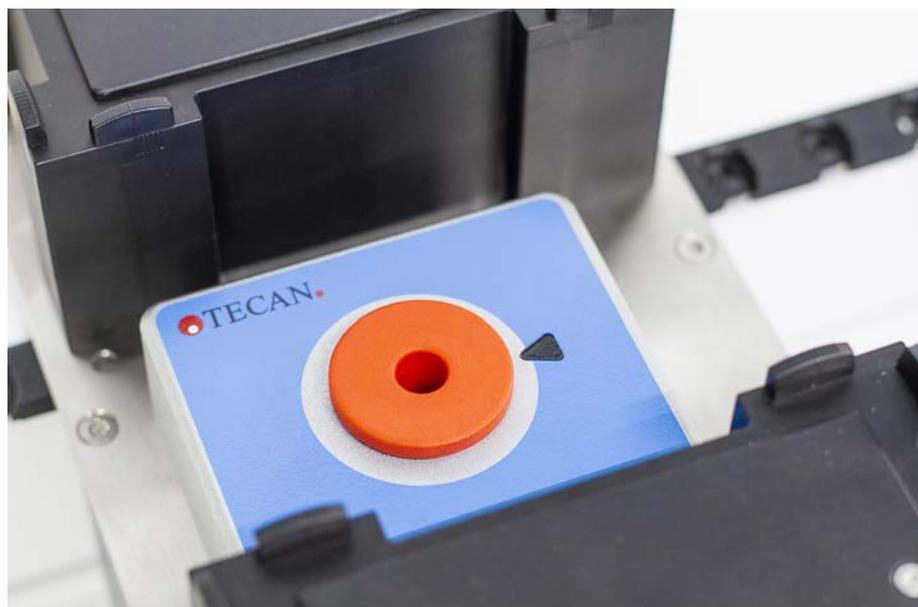
*Fig. 62: Bouchon d'obturation du Frida Reader*
