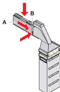
Fig. 49: Remettre en place la station de lavage
