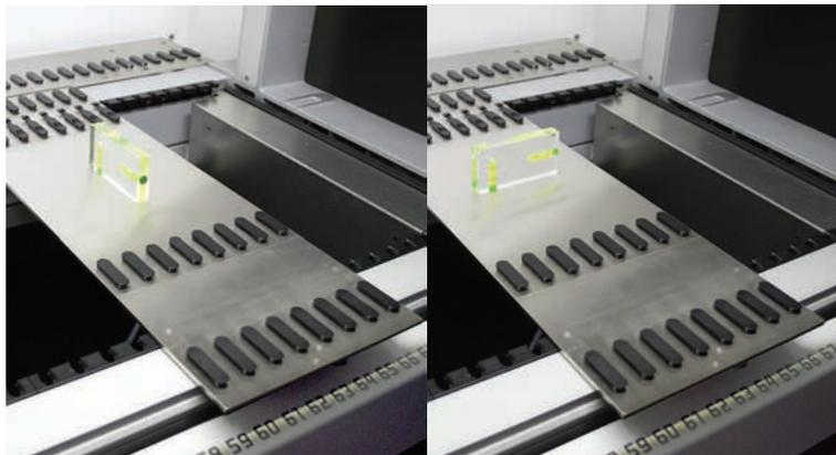
4. À l'aide d'un niveau à bulle, vérifier que l'appareil est aligné horizontalement et verticalement.
