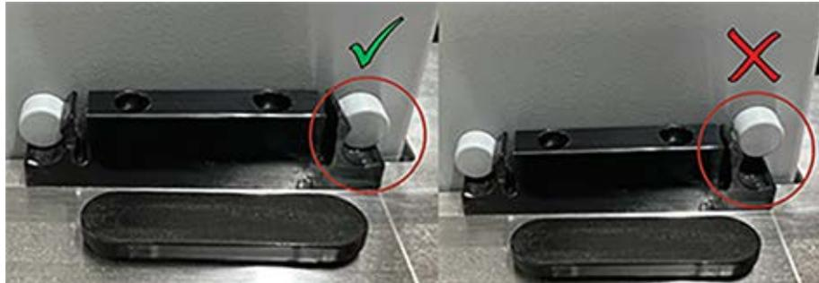
Fig. 57: Montage correct de la glissière d'évacuation sur la table de travail
