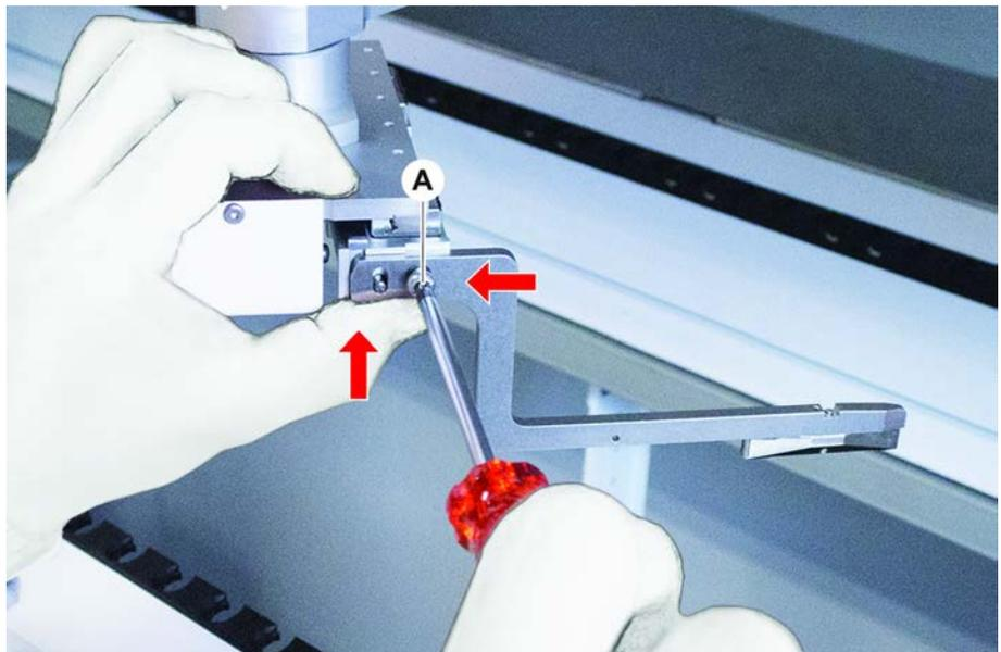
2. Appuyer les doigts préhenseurs contre la butée supérieure et la butée arrière du support de la tête de préhension et serrer la vis au tournevis dynamométrique (3 ou 3,5 Nm).
