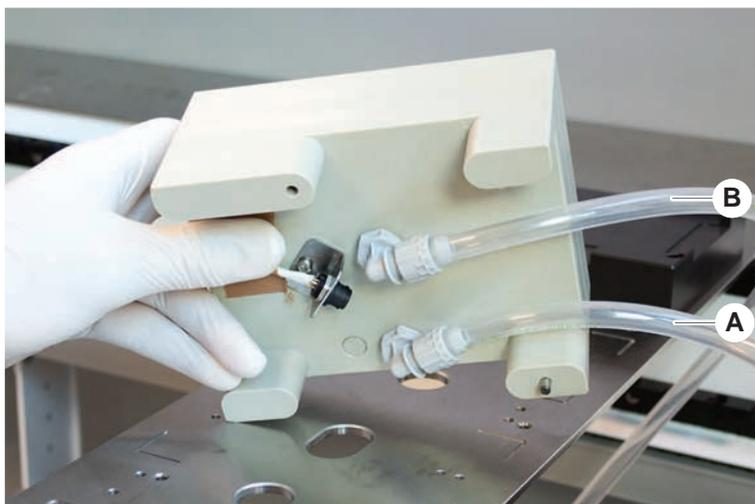
3. Raccorder le tube de lavage (A) et le tube d'évacuation (B).
