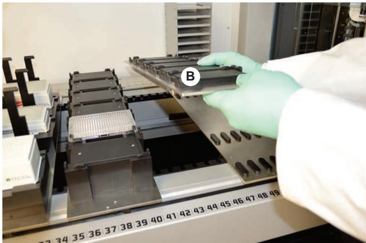
Débrancher le câble avant de retirer un support actif MCA.
