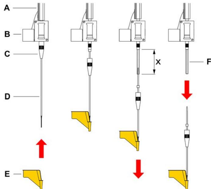
Fig. 67: Extraction des embouts de perçage
