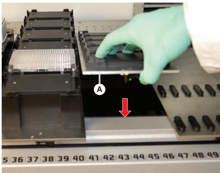
5. Tourner le levier de serrage de gauche à droite, en position fermée. Voir la section "[Vérification du segment](#)" [ 202].
