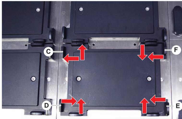
3. Glisser le dispositif de positionnement coulissant diagonal (E) vers le récipient ou l'en écarter pour qu'il s'adapte exactement à l'appareil.
