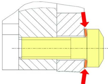
Si vous n'avez pas de tournevis dynamométrique, serrez la vis jusqu'à ce que la rondelle s'aplatisse et que la résistance augmente. Puis serrez  $1/12$  de rotation de plus. Cela correspond environ à 3,5 Nm.
