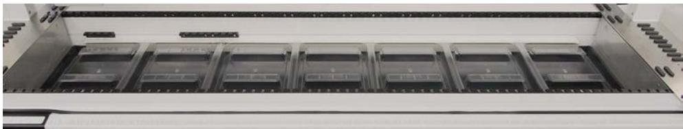
Fig. 20: Bacs sous les segments de plateau
