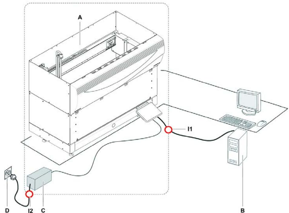
Fig. 16: Connexions des données et de l'alimentation
