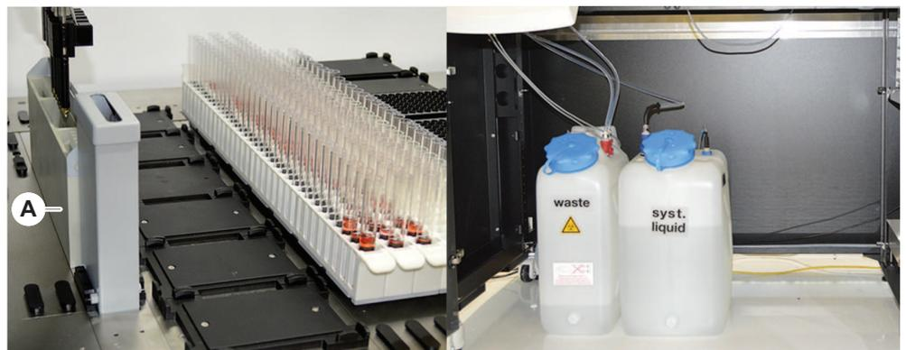
Fig. 27: Système de liquide (Liquid FCA)
