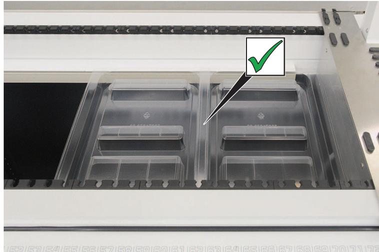
Fig. 44: Bacs positionnés correctement
