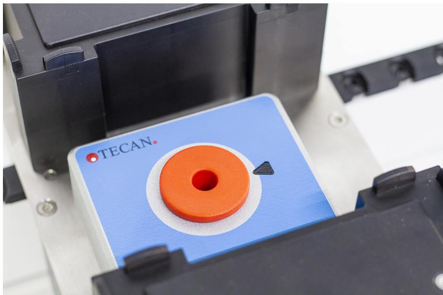
*Fig. 59: Bouchon d'obturation du Frida Reader*
