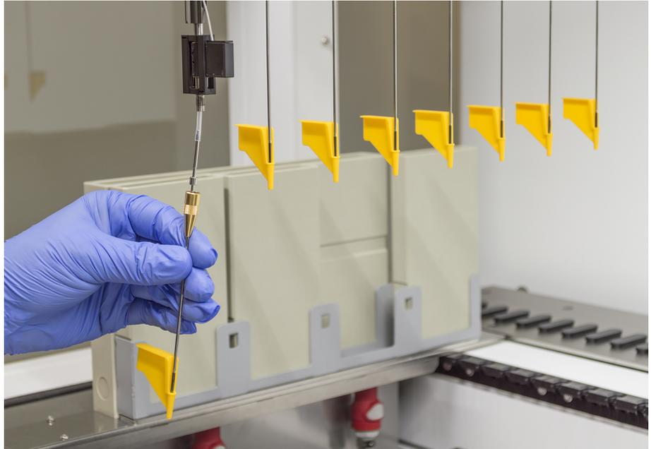
8. Tirer l'embout de perçage du tube tout en maintenant le tube de l'autre main.
