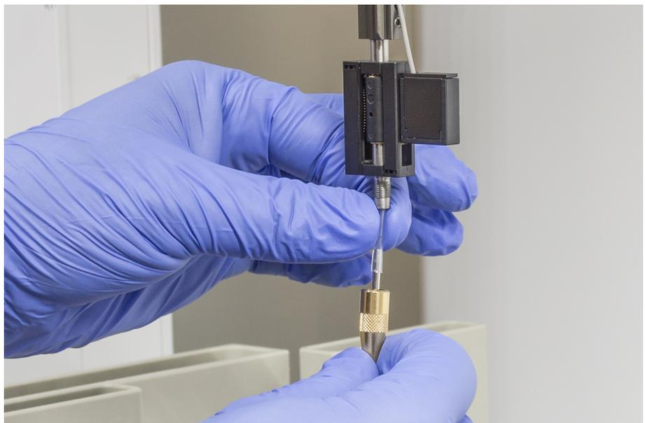
8. Insérer l'embout de perçage et le tube de pipetage dans l'adaptateur d'embout.
