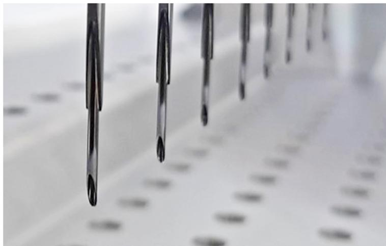
13. Après avoir installé tous les embouts de perçage, retirer toutes les protections des embouts. Commencer par l'embout de perçage le plus en arrière.
