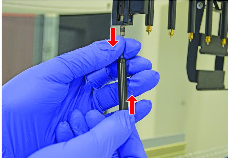
4. Tenir l'adaptateur d'embout (D) et le tube éjecteur d'embout (C).
