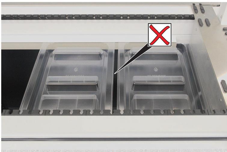
Fig. 42: Bacs mal positionnés
