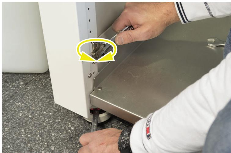
6. Après avoir mis l'appareil à niveau, resserrer les écrous-freins des pieds du châssis.
