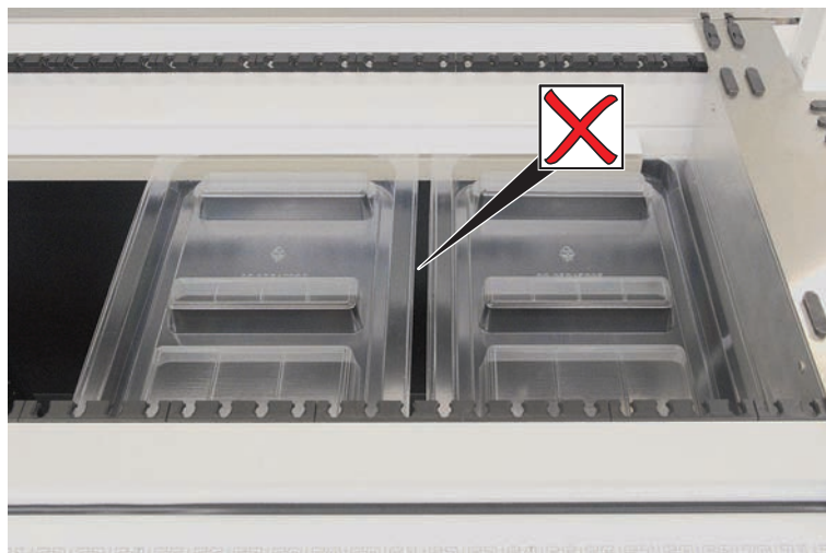
Fig. 44: Bacs mal positionnés
