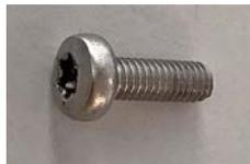
b) Vite a esagono incassato M4x12 in combinazione con una rondella di tensione (osservare la posizione come da figura seguente), serrata a una coppia di 3,5 Nm.
