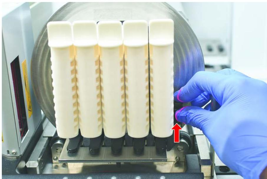
2. Tirare il portaprovette in senso orizzontale lungo il piano di lavoro fino alla sua completa rimozione.
