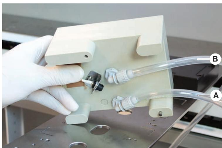
3. Collegare il tubo flessibile di lavaggio (A) e il tubo flessibile di scarico (B).
