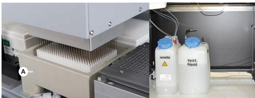
Fig. 29: Sistema di lavaggio (MCA)
