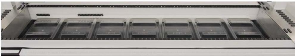
Fig. 20: Vaschette di raccolta sotto i segmenti del piano di lavoro
