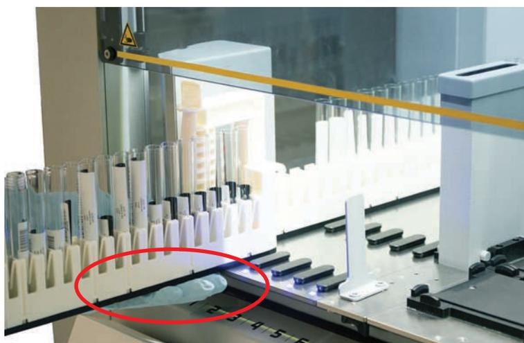
5. Inserire i portaprovette in successione sulle apposite griglie nell'area di carico di Fluent ID.
