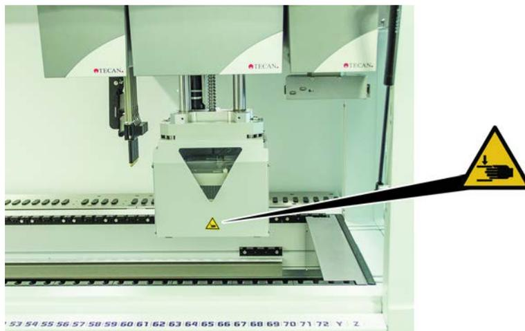
Fig. 11: Avviso di sicurezza sul braccio MCA 384
