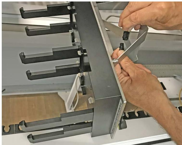
2. Abbassare il segmento sul lato posteriore del piano di lavoro.
