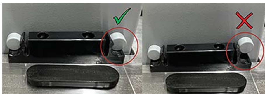
Fig. 57: Montaggio corretto dello scivolo di scarico sul piano di lavoro
