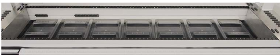
Fig. 20: Vaschette di raccolta sotto i segmenti del piano di lavoro
