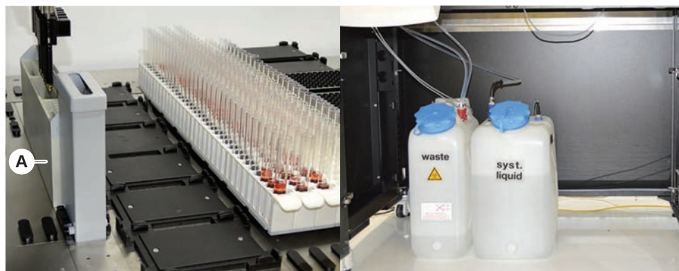
Fig. 28: Sistema di dispensazione del liquido (Liquid FCA)
