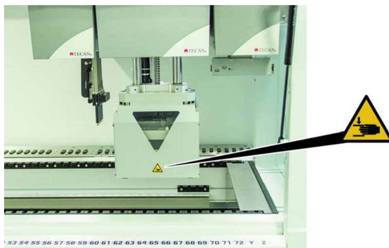
Fig. 11: Avviso di sicurezza sul braccio MCA 384
