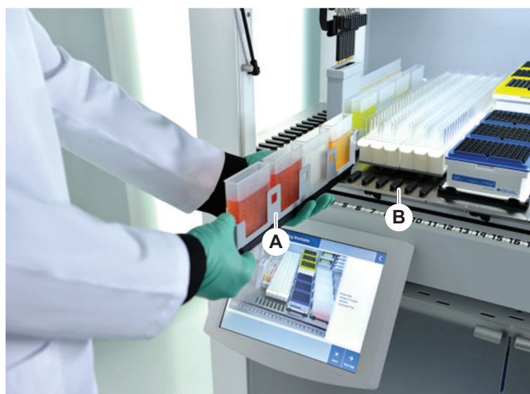
図 18: Fluentのデッキ
