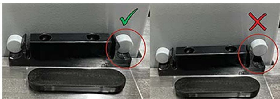
図 57: 廃棄シュートをワークテーブルに正しく取り付ける
