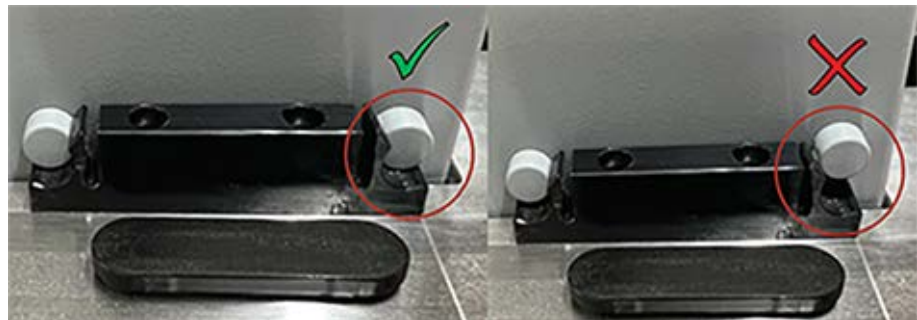
그림 57: 작업대에 폐기물 처리구를 적절하게 설치하는 방법
