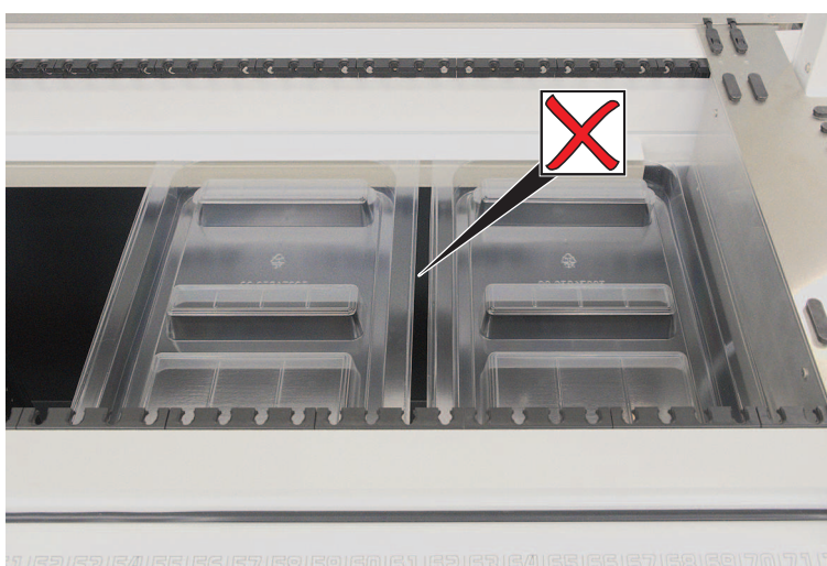
Fig. 42: Feil dekkbrett plassering
