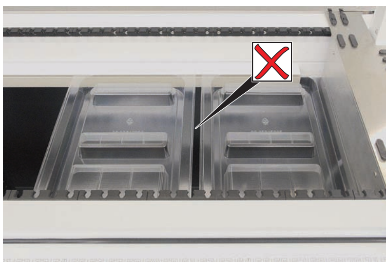
Fig. 44: Feil dekkbrett plassering
