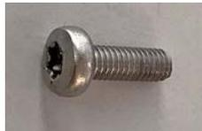
b) parafuso Allen M4x12 em combinação com um anilha tensora (observar a posição de acordo com a ilustração abaixo), apertado com um binário de 3,5 Nm.
