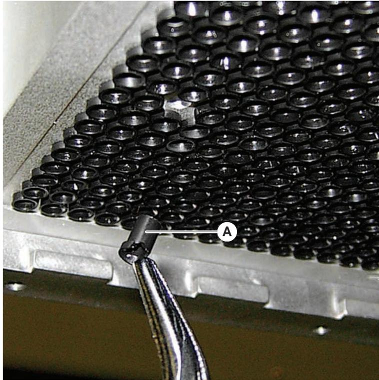
7. Lubrifique a junta nova com uma fina camada de óleo mineral.
