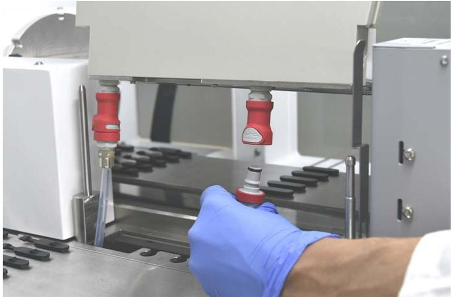
2. Monte a estação de lavagem nos eixos de orientação (A) e pressione-a verticalmente na direção da placa base. Verifique se a alavanca de libertação encaixa devidamente e fixa a estação de lavagem no respetivo lugar.
