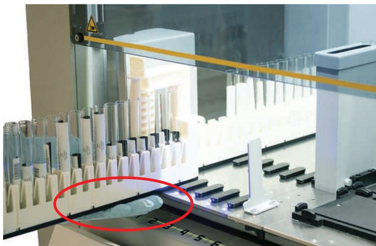
5. Faça deslizar as calhas de tubos, uma após a outra, nas grelhas dedicadas na área de carregamento do Fluent ID.
