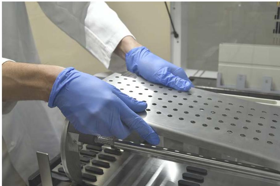
3. Limpe a placa do fixador de acordo com as instruções gerais acima ou, em alternativa, o fixador do tubo pode ser incubado num banho com 2% lixívia por um período máximo de 2 horas.
