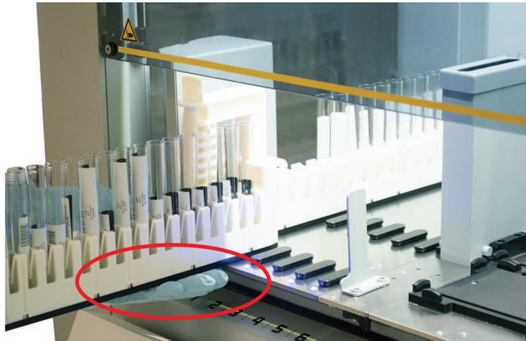
5. Faça deslizar as calhas de tubos, uma após a outra, nas grelhas dedicadas na área de carregamento do Fluent ID.
