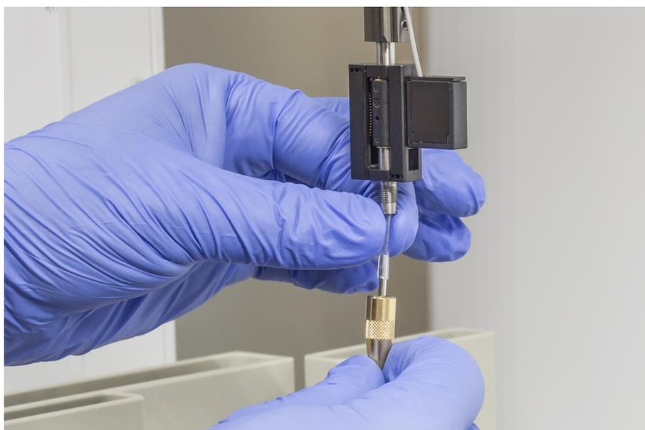
8. Introduza a ponta de perfuração e a tubagem de pipetagem no adaptador de pontas.
