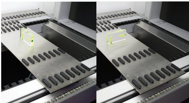
4. Utilize o nível de bolha para garantir que o instrumento está alinhado horizontal e verticalmente.
