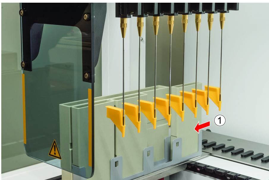
6. Desenrosque a porca de fixação segurando imediatamente com a outra mão a ponta de perfuração por baixo da porca de fixação.
