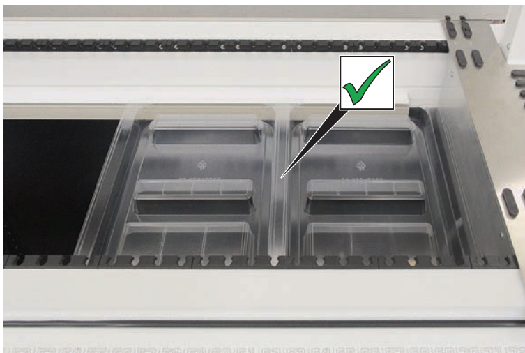
Fig. 46: Colocação correta do tabuleiro de recolha
