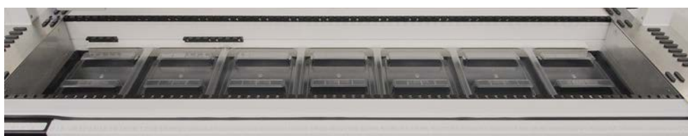
Fig. 20: Tabuleiros de recolha por baixo dos segmentos da mesa de trabalho
