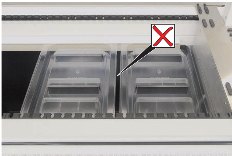
Рис. 44: Неправильное размещение поддона рабочей платформы
