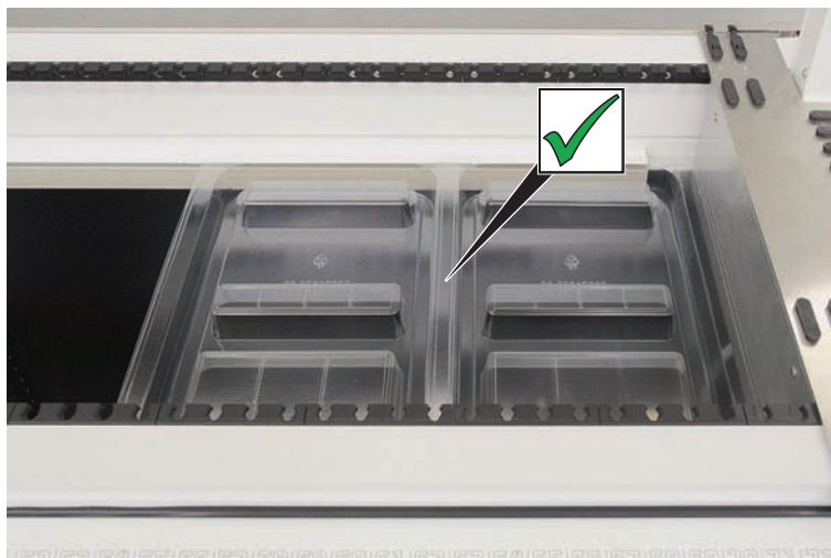
Рис. 46: Правильное размещение поддона рабочей платформы
