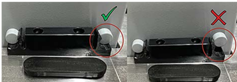
Рис. 57: Правильное крепление желоба для отходов на рабочем столе
