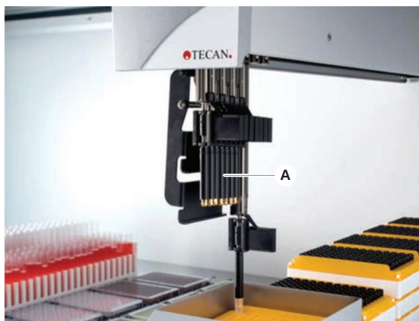
Рис. 23: Манипулятор с гибким каналом
