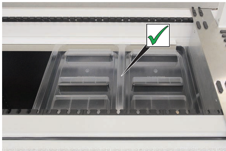
Рис. 46: Правильное размещение поддона рабочей платформы
