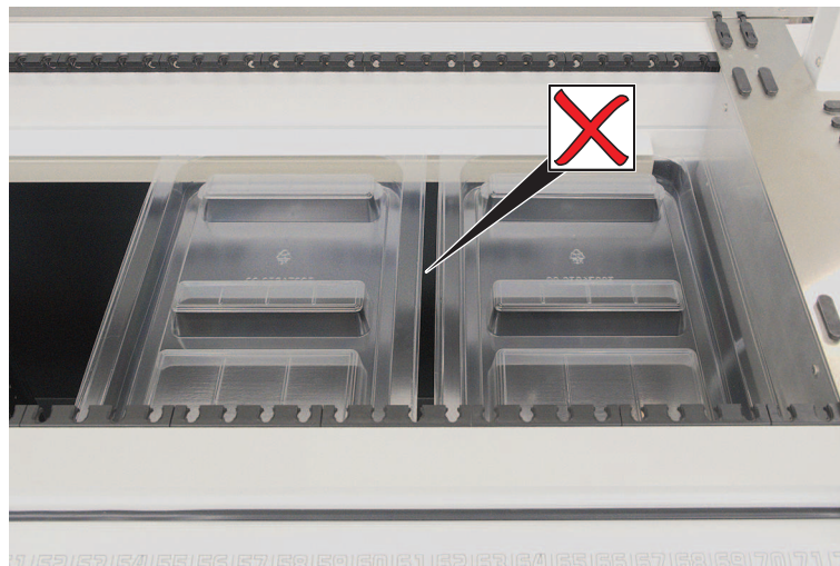
Fig. 42: Felaktig placering av bänkbrickor
