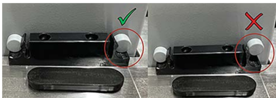
图 57: 将抛弃槽安装到工作台上正确位置
