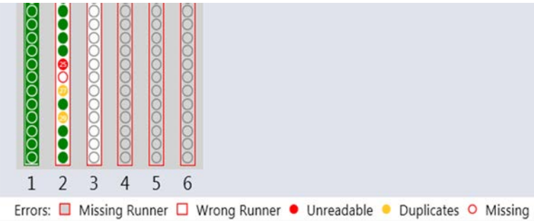
图 42: 触摸屏上显示的条形码读取确认
