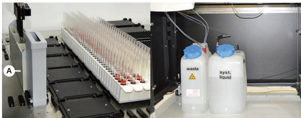
Obr. 26: Kapalinový systém (FCA s kapalinovým systémem)
