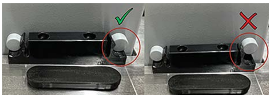
Obr. 54: Správná montáž odpadního skluzu na pracovním stole
