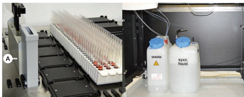
Fig. 26: Sistema de líquidos (líquido FCA)
