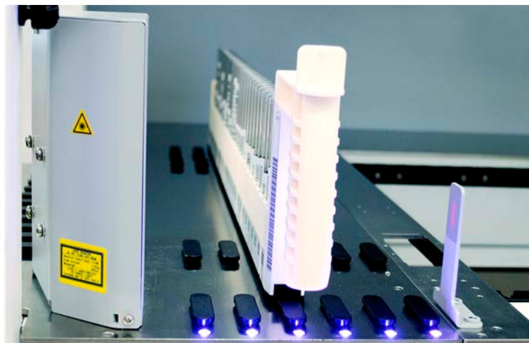
Fig. 38: LEDs de Fluent ID
