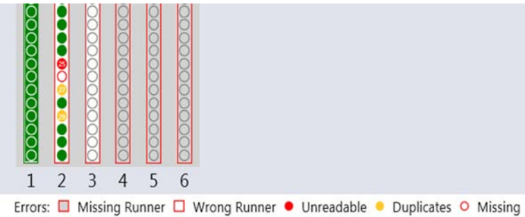
Fig. 39: Confirmación de la lectura del código de barras visualizada en la pantalla táctil
