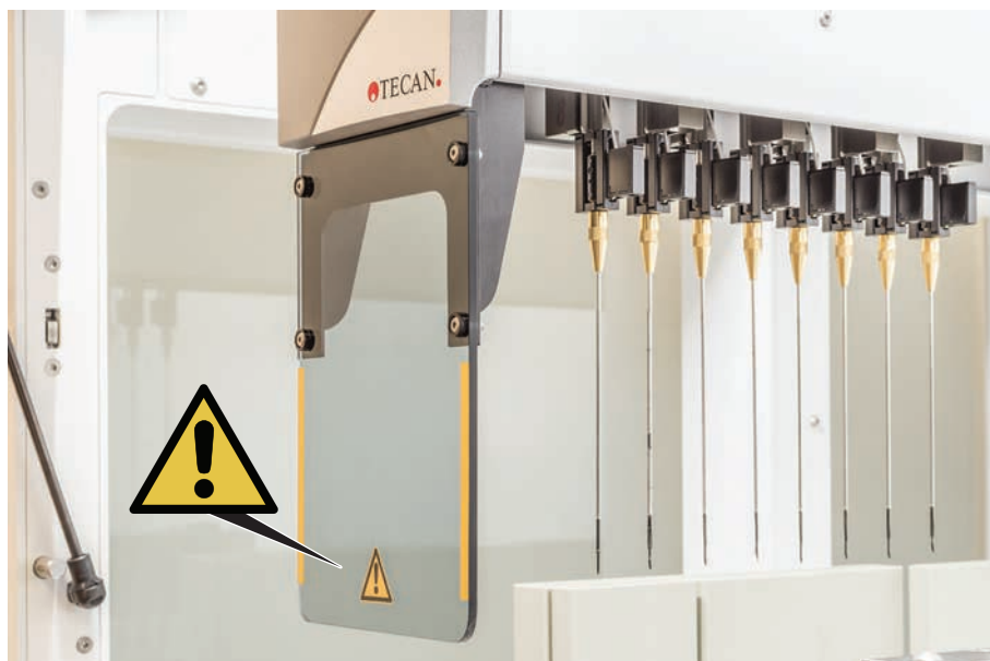
Fig. 12: Placa de seguridad
