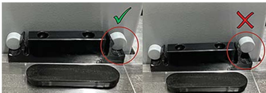
Fig. 54: A hulladékcsatorna megfelelő felszerelése a munkaasztalra
