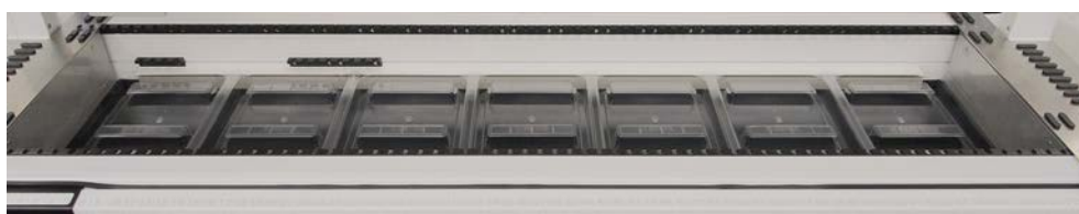
Fig. 19: Vaschette di raccolta sotto i segmenti del piano di lavoro
