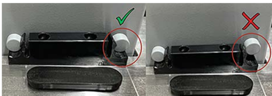
Fig. 54: Montaggio corretto dello scivolo di scarico sul piano di lavoro
