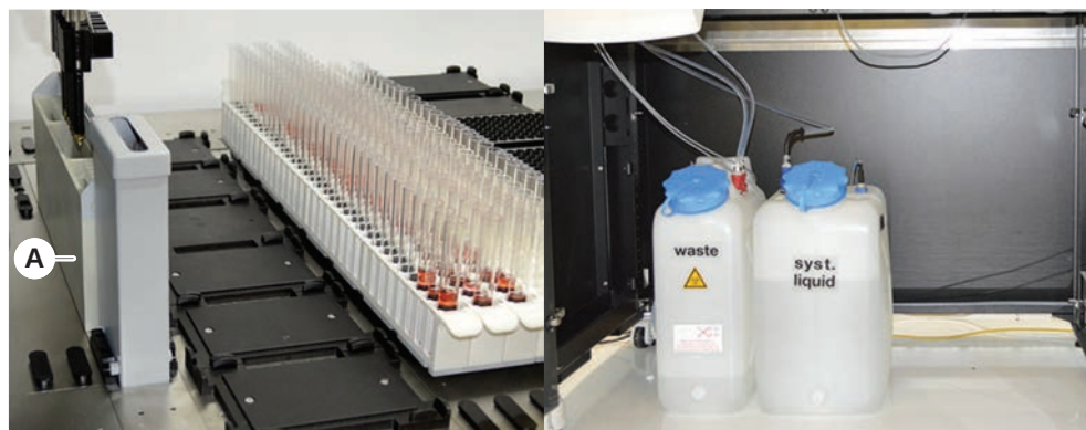
Fig. 26: Sistema di dispensazione del liquido (Liquid FCA)
