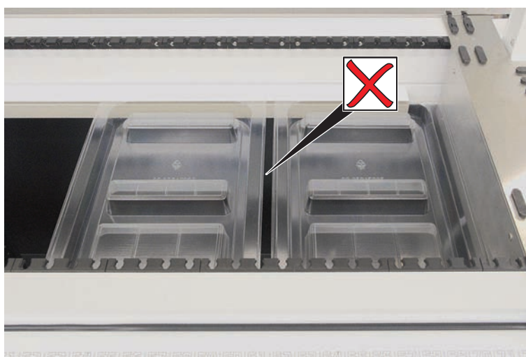
Fig. 41: Colocação incorreta do tabuleiro de recolha
