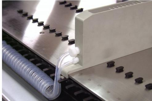
Die Kleinvolumen-Waschstation hat zwei Flüssigkeitsanschlüsse. Sie ist mithilfe einer Klemmplatte und einer Schraube an der Arbeitsfläche befestigt.
