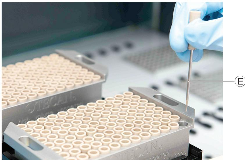
**Abb. 7-39** Stahlspitze entfernen
