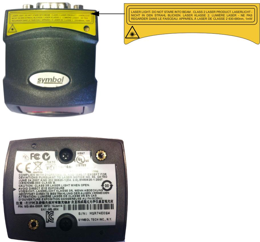
**Abb. 2-14** Laserkennzeichnung am Symbol-BC-Lesegerät
