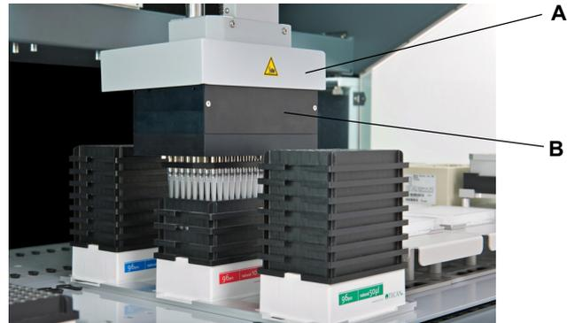
**Abb. 2-4** Sicherheitselemente / Abdeckungen am Pipettierkopf mit 96 Kanälen
