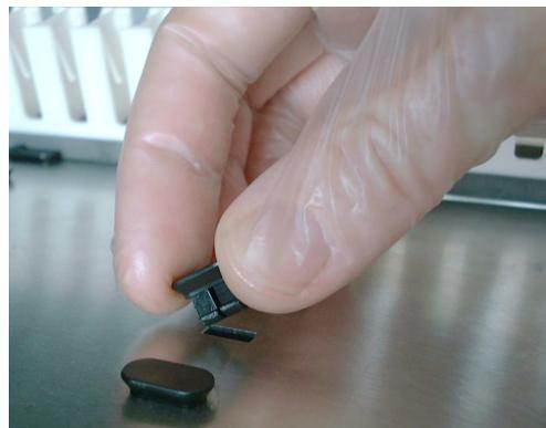
**Abb. 7-51** Einsetzen eines Positionierzapfens
