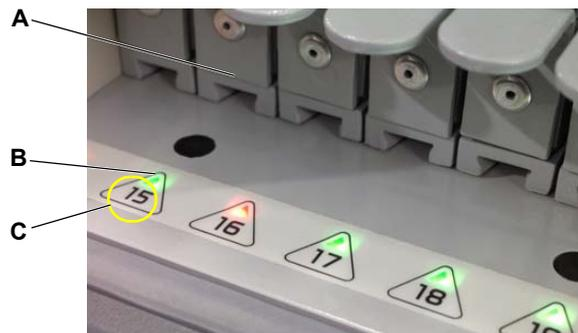
**Abb. 6-3** Anzeige-LEDs der Beladeeinrichtung
