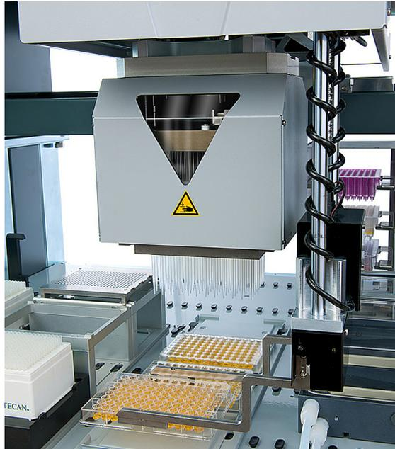
Abb. 4-35 Pipettierkopf mit 384 Kanälen
