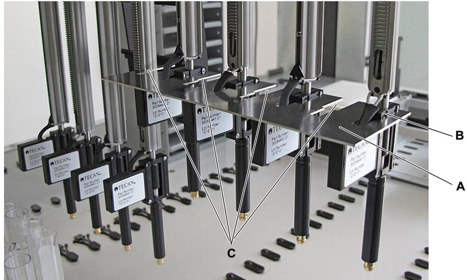
**Abb. 7-9** Einsetzen der Einstelllehre für Air LiHa-Spitzenadapter
