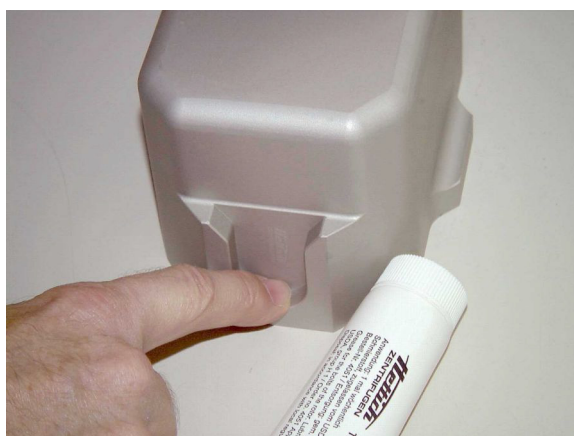
Fig. 7-48 Engrase de la superficie de los cojinetes
