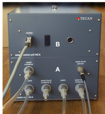
Sistema de lavado del MCA
