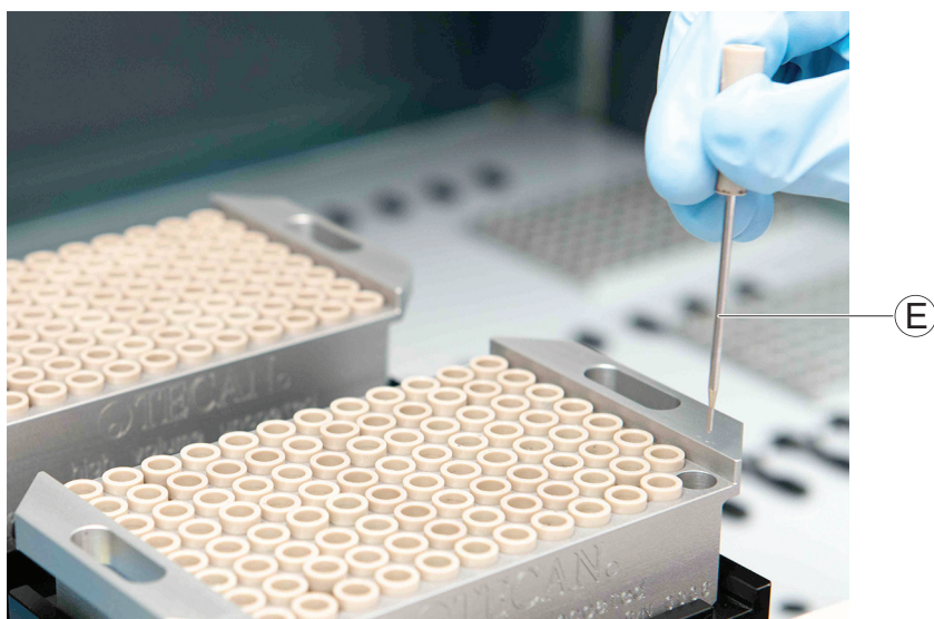
Fig. 7-39 Extracción de la aguja de acero
