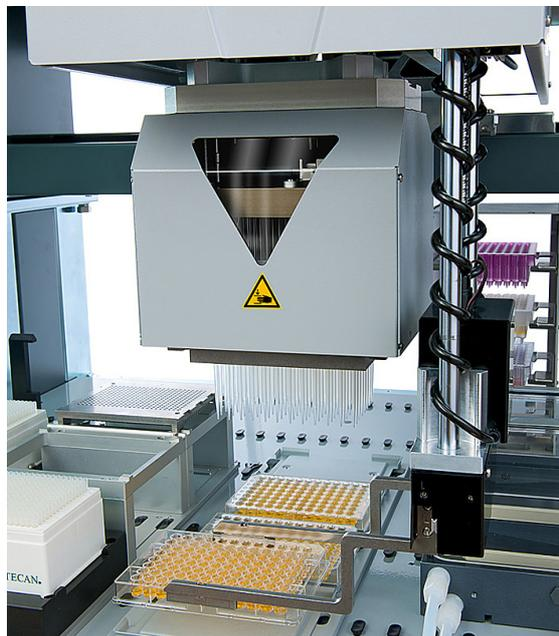
Fig. 4-35 Tête de pipetage à 384 canaux
