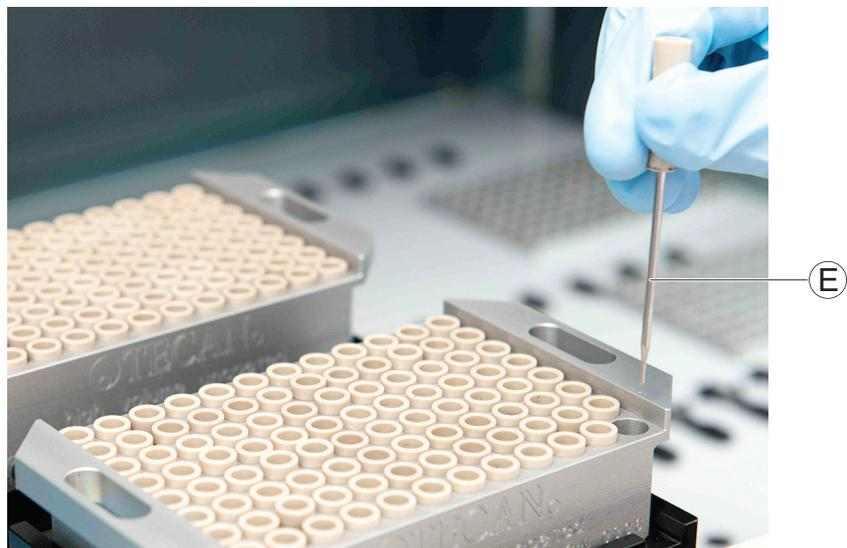
**Fig. 7-39** Retirer l'aiguille en acier
