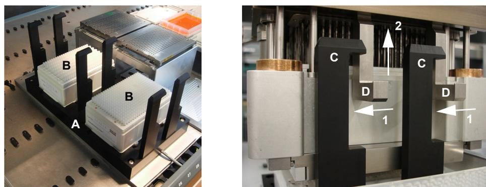
**Fig. 4-50** Mécanisme de prélèvement des DiTi
