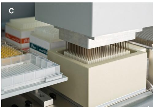
**Fig. 4-43** Adaptateur d'embouts en acier 125 µl MCA384
