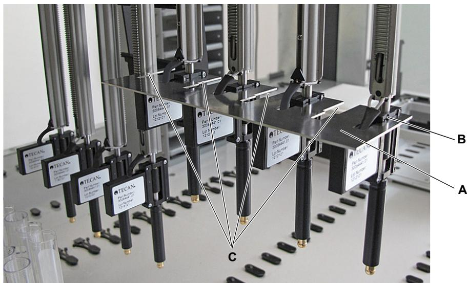
**Fig. 7-9** Insertion de la jauge d'ajustement pour adaptateurs d'embouts Air LiHa
