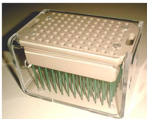
*Fig. 6-8 Boîte de bloc d'embouts en acier*
