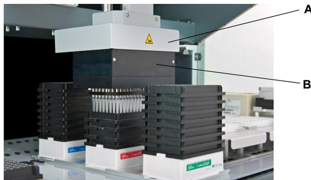
**Fig. 2-4** Éléments/caches de sécurité sur la tête de pipetage à 96 canaux
