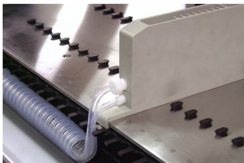
La station de lavage faible volume ne dispose que de deux connexions de liquide. Elle est fixée à la table de travail au moyen d'une plaque de serrage et d'une vis.
