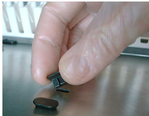
**Fig. 7-51** Insertion d'une goupille de positionnement
