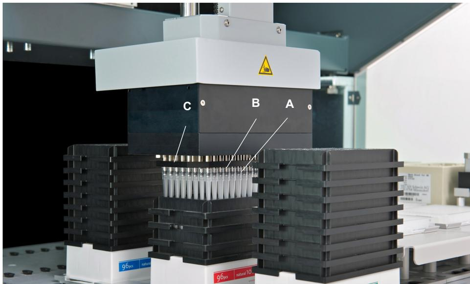
**Fig. 4-15** Adaptateur d'embout
