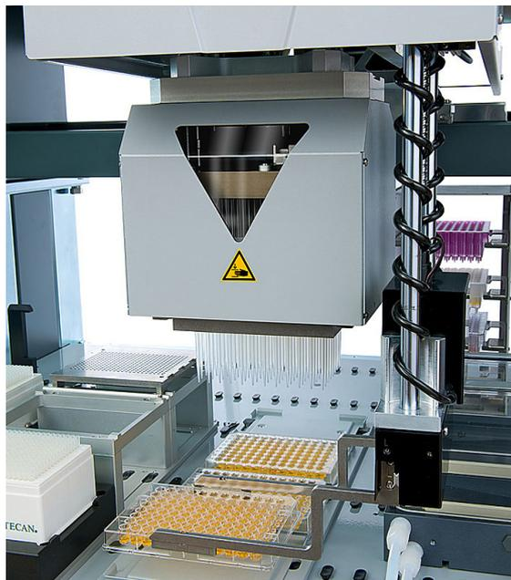
Fig. 4-35 Testa meccanica per pipettaggio da 384 canali
