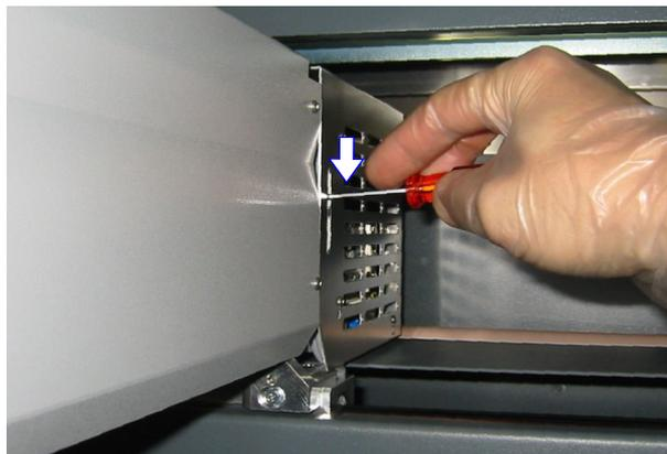
**Fig. 8-3** Fessura per accedere alla leva di rilascio del freno
