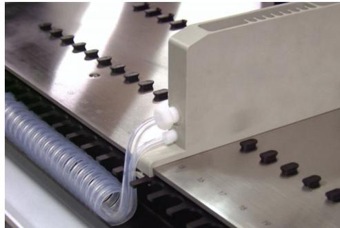
La stazione di lavaggio Low Volume dispone di due raccordi del liquido. È fissata al piano di lavoro mediante una piastra di fissaggio e una vite.
