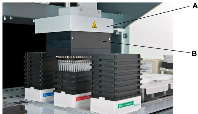
**Fig. 2-4** Elementi di sicurezza/coperture sulla testa meccanica per pipettaggio a 96 canali
