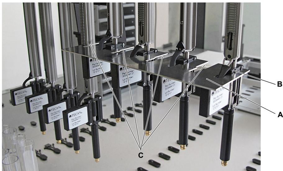
**Fig. 7-9** Inserimento del calibro di regolazione per adattatori dei puntali del braccio Air LiHa
