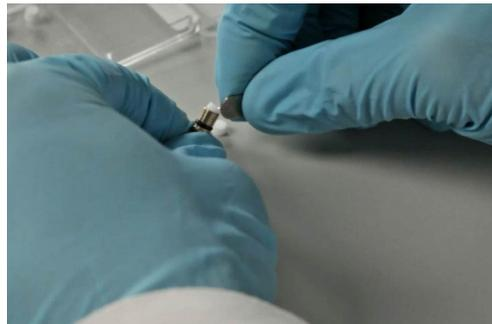
**Fig. 7-14** Rimozione del filtro in linea
