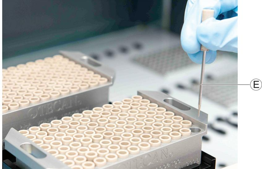
**Fig. 7-39** Rimozione di un ago in acciaio
