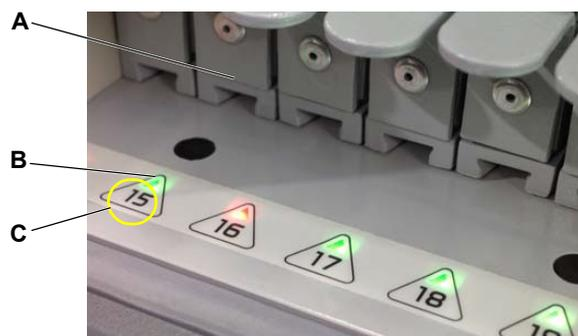
**Fig. 6-3** Spie LED dell'interfaccia di carico
