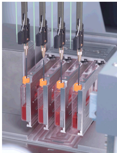
Afb. 4-92 Kolfkeerder in verticale positie voor septum doorprikken en pipetteren
