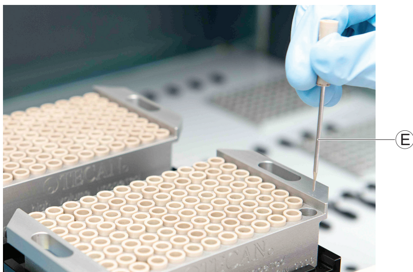
Afb. 7-39 Stalen naald verwijderen
