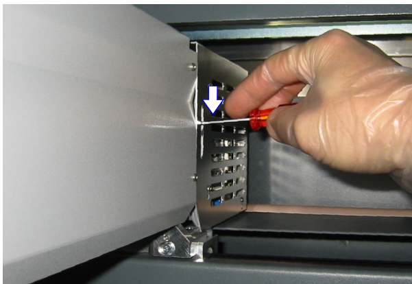
Рис. 8-3 Щель для отпускания тормоза
