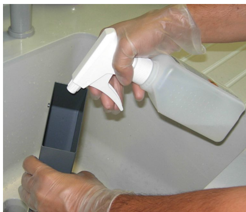
Рис. 7-22 Спускной желоб для отработанных одноразовых наконечников
