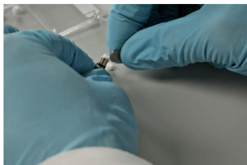
Рис. 7-14 Извлечение проходного фильтра
