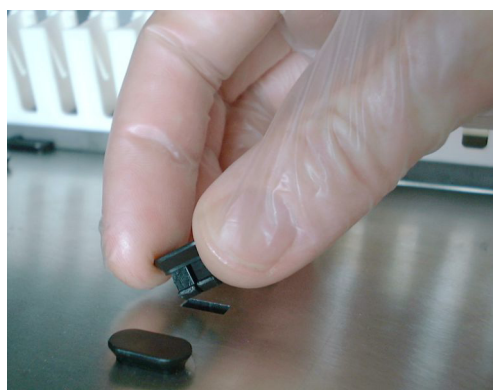
Рис. 7-51 Установка направляющего штифта
