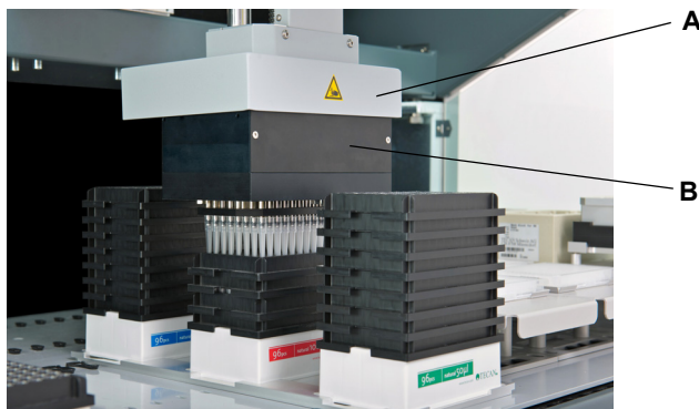
Рис. 2-4 Элементы безопасности/крышки 96-канальной пипетирующей головки
