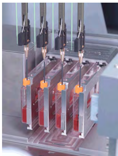
图 4-92 Flask flipper 在垂直位置时用于穿孔和移液。
